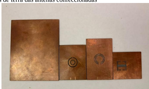
Figura 14 - Vista dos planos de terra das antenas confeccionadas
