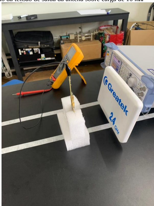
Figura 15 - Setup de medição da tensão de saída da antena sobre carga de 10 k \Omega
