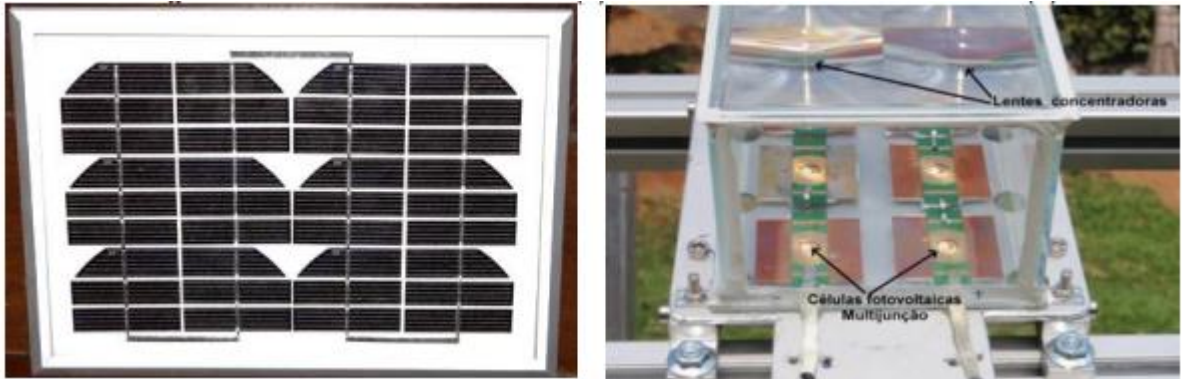
Figura 13 - Módulos fotovoltaicos PV (a) e com lentes concentradoras CPV (b)
