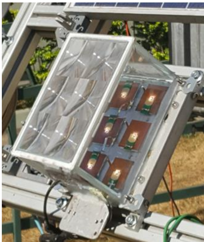
Figura 35 – Módulo fotovoltaico concentrador instalado no CPEI, no CEFET–MG.
