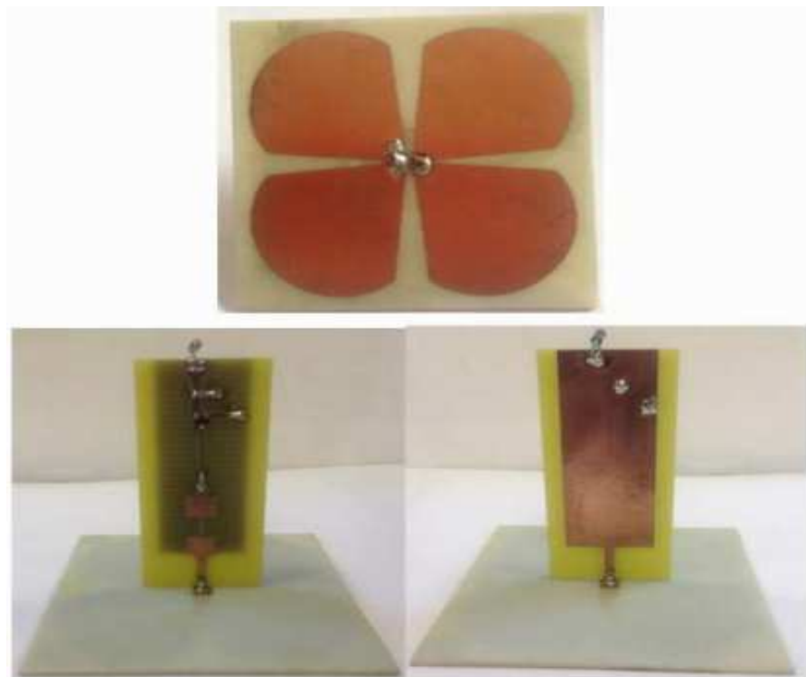
Figura 2.14 - Protótipo construído da rectenna 14 (Zhang, Huang, & Cao, 2014).
