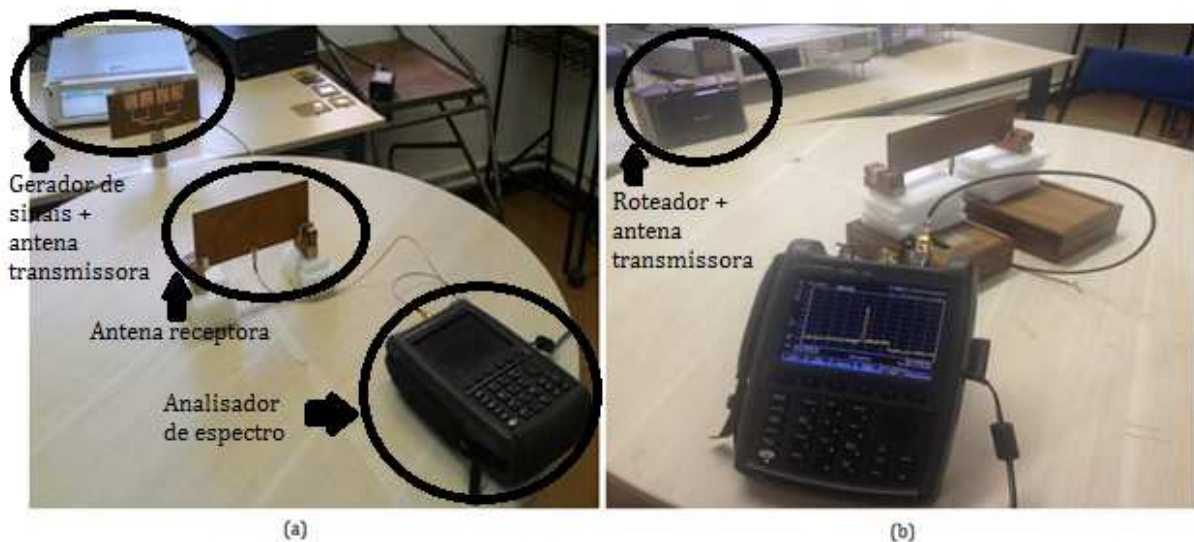
Figura 3.19 – Sistema transmissão-recepção utilizado para (a) transmissão de energia sem fio e (b) reaproveitamento de energia eletromagnética.
