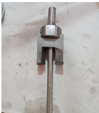
Figura 14 – Ferramenta de rebaixamento da sede de molas.
