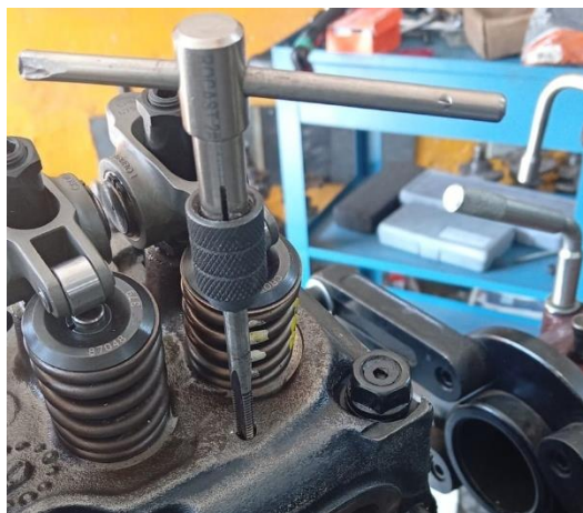
Figura 5 – Passagem do macho para limpeza.
