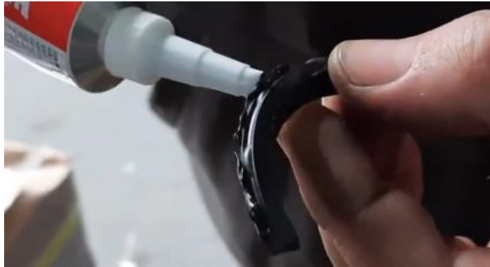
Figura 19 – Aplicação do selante.
