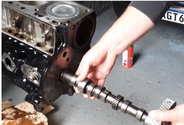
Figura 33 – Inserção do comando no orifício do bloco.
