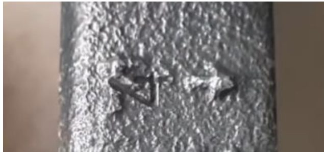
Figura 23 – Marcações de referência de cilindro e frente do motor.
