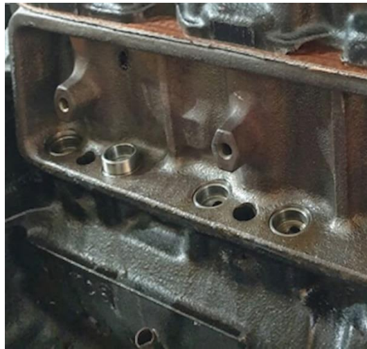
Figura 38 – Tuchos posicionados nos alojamentos do bloco.
