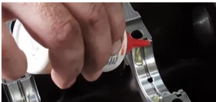
Figura 20 – Lubrificação das bronzinas
