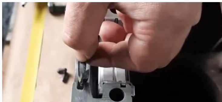
Figura 18 – Inserção do retentor de óleo.
