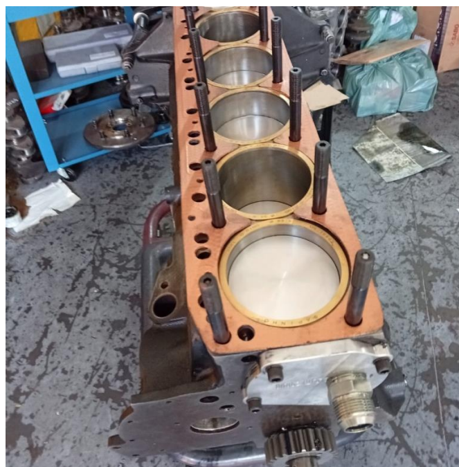
Figura 40 – Junta de estanho e O-rings posicionados.
