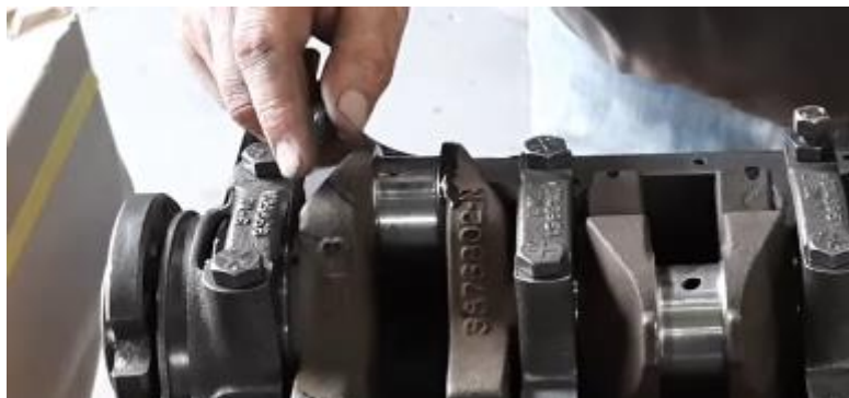
Figura 11 – Medição de folga axial.
