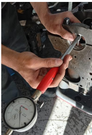
Figura 12 – Medição da folga radial
