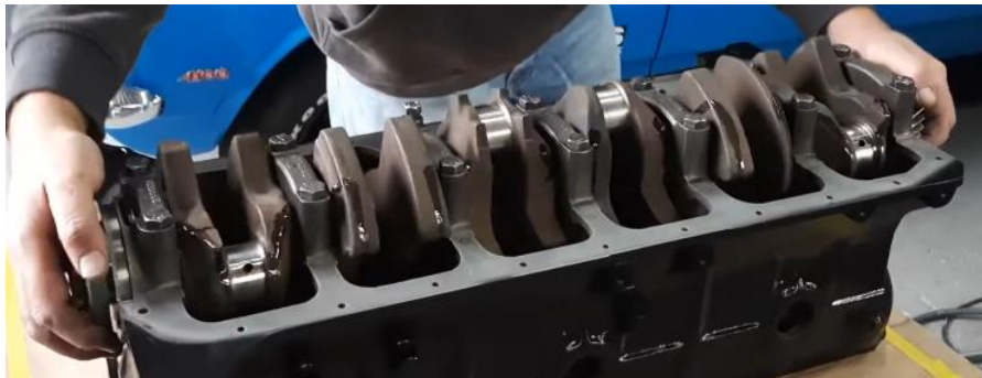
Figura 31 – Verificação de giro do virabrequim.
