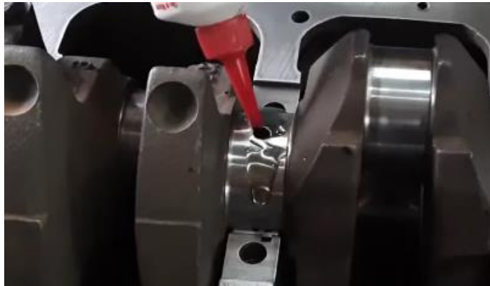
Figura 21– Lubrificação dos munhões do virabrequim.
