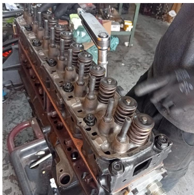
Figura 41 – Posicionamento do cabeçote e fixadores.
