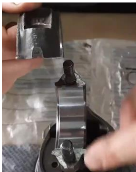
Figura 30 – |Marcação de referência para alinhamento de corpo e tampa de biela.
