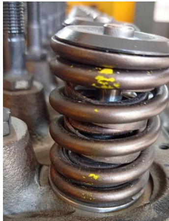
Figura 13 – Mola instalada com arruela de 0,2 mm.
