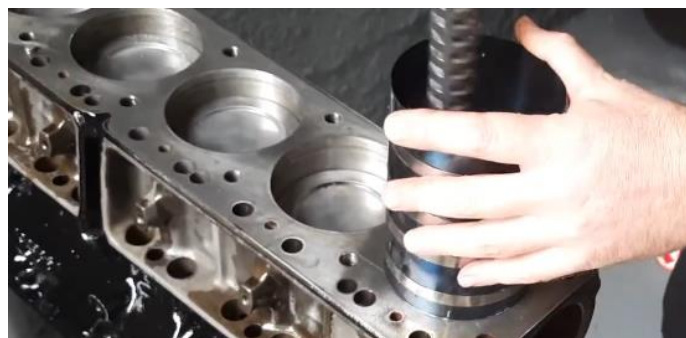
Figura 29 – Inserção do conjunto biela-pistão no cilindro.
