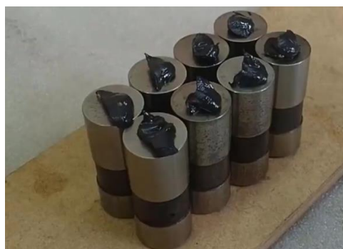
Figura 37 – Tuchos mecânicos lubrificados com pasta de montagem.
