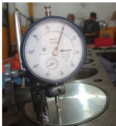
Figura 34 – Aferição do PMS.
