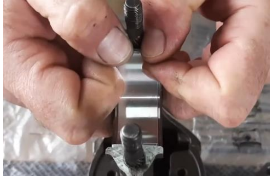
Figura 27 – Assentamento das bronzinas de biela.
