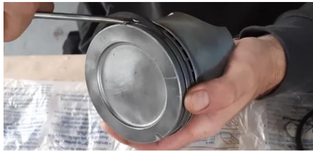
Figura 26 – Inserção do anel de vedação do pistão
