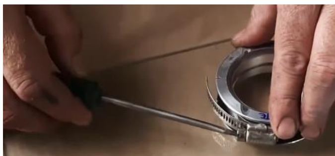
Figura 8 – Semi-carcaças unidas com braçadeiras.
