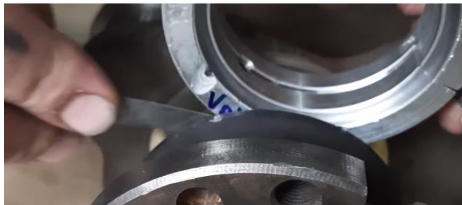
Figura 9 – Medição de folga com calibre
