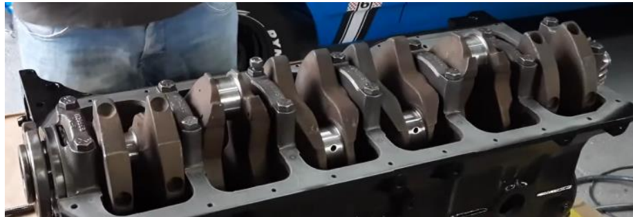
Figura 10 – Tampas de mancal montadas.
