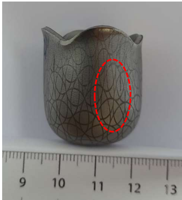
Figura 42 - Corpo de prova com a formação de elipses após conformação
