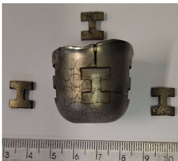
Figura 45 - Regiões onde foram retiradas as amostras para microdureza Vickers.
