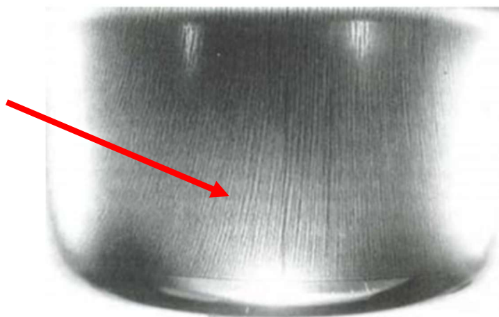
Figura 24 - Copo trefilado profundo de grau AISI 430 mostrando o fenômeno “roping”.
