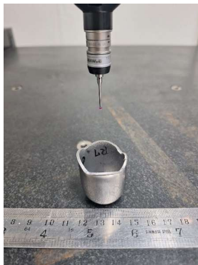
Figura 43 - Medição da profundidade interna do blank estampado
