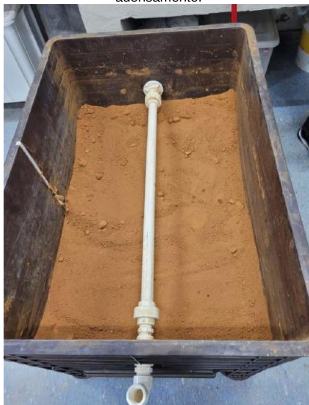
Figura 7: Primeira camada de solo na bancada experimental e fita métrica para controle do adensamento.
