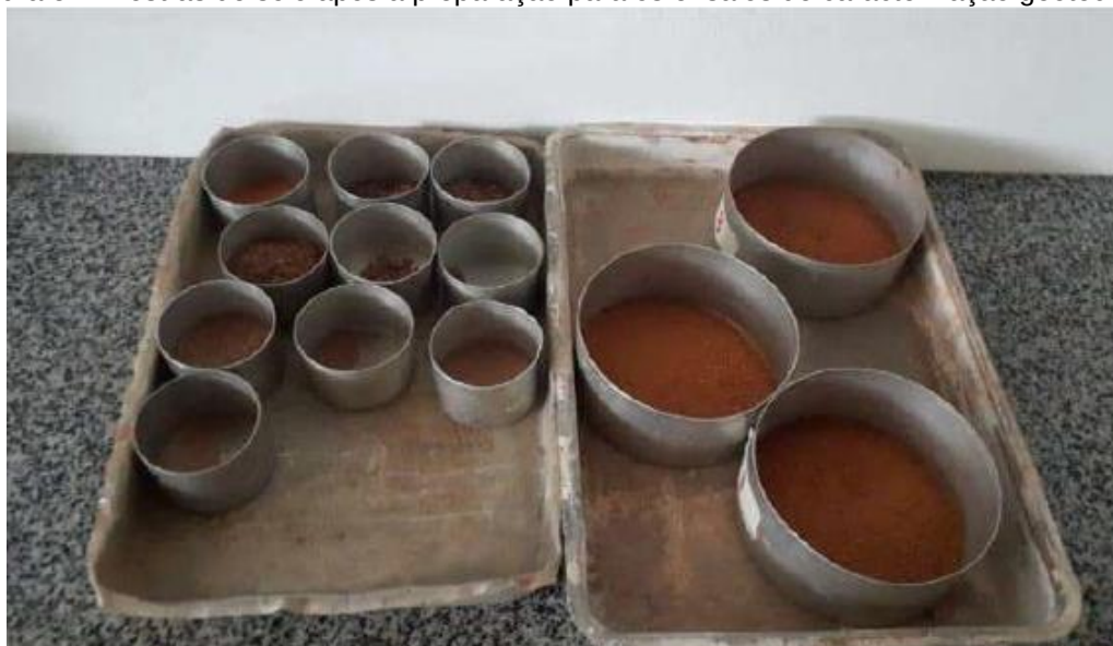
Figura 5: Amostras de solo após a preparação para os ensaios de caracterização geotécnica.
