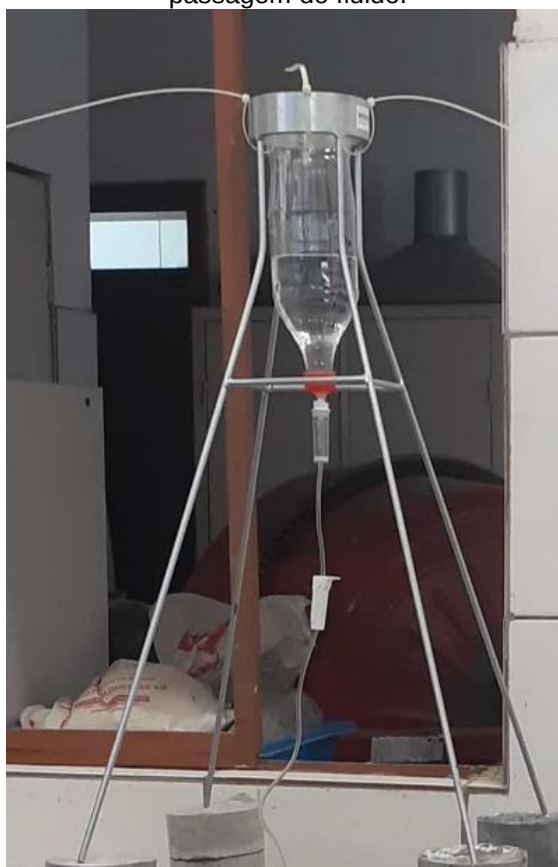
Figura 8: Representação esquemática do sistema hidráulico utilizado na bancada experimental, evidenciando o reservatório superior (garrafa PET) e o equipo como elemento de controle manual da passagem do fluido.
