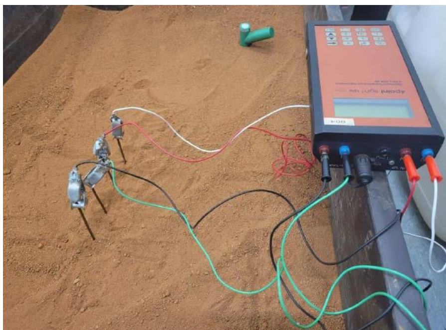
Figura 4: Quatro eletrodos com espaçamento de 0,05m ligados ao aparelho 4 point light 10 W.
