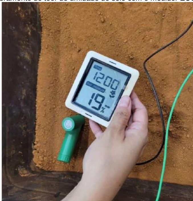
Figura 6: Monitoramento do teor de umidade do solo com o medidor ECOWITT WH0291.
