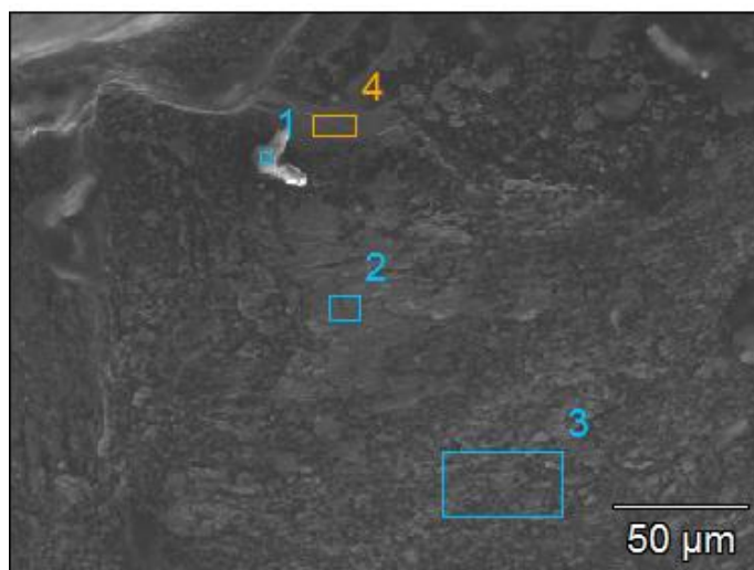
Figura 38 – Análise (MEV) dos Pontos Analisados – Corte Contínuo V_c = 130 m/min
