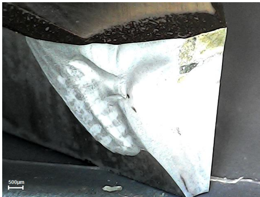
Figura 48 - Estado Final da Ferramenta – (Corte contínuo – Velocidade de Corte 240 m/min)
