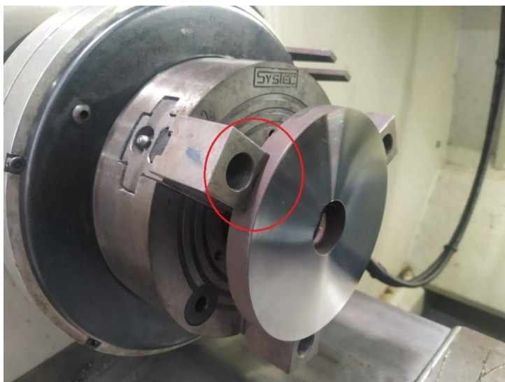
Figura 22 - Fixação do Corpo de Prova na Placa com Castanhas Usinadas
