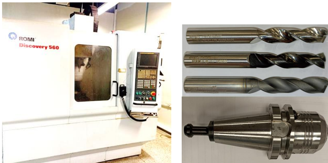
Figura 34 :Centro de usinagem CNC Romi Discovery 560
