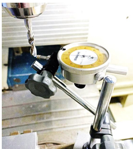
Figura 35: Montagem do relógio comparador analógico
