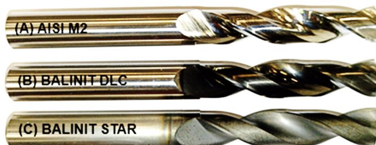
Figura 27: Brocas em AISI M2 sem revestimento (A) e revestida (B) BALINIT DLC) e (C) DLC STAR
