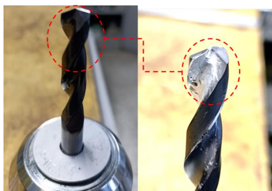
b) Adesão na aresta de corte com revestimento Tipo A
