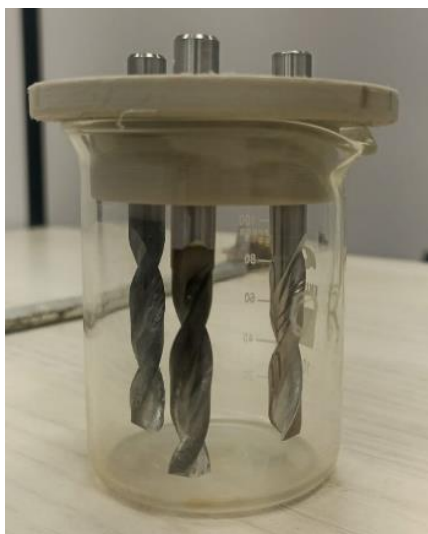
Figura 39: Procedimento de decapagem das ferramentas de corte
