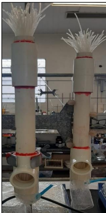
Figura 20. Confeção dos módulos de membranas de ultrafiltração
