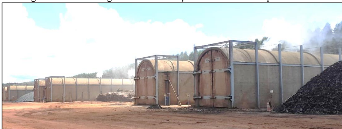
Figura 2. Forno retangular da carbonização da madeira da empresa Alterosa
