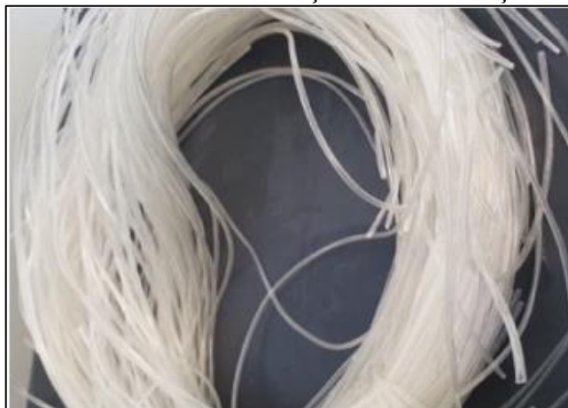
Figura 17. Membranas de ultrafiltração na conformação de fibra oca
