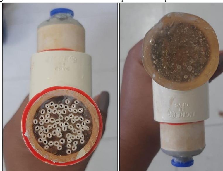
Figura 21. Extremidades do cano após introdução das membranas
