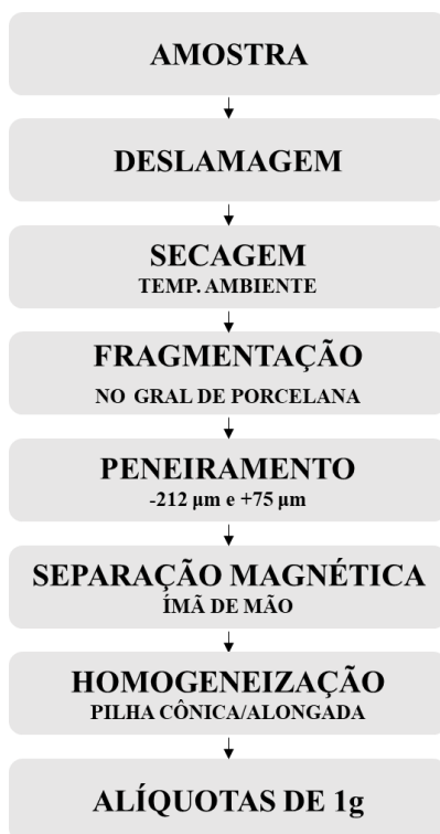
Figura 18: Fluxograma de preparação e purificação da apatita.
