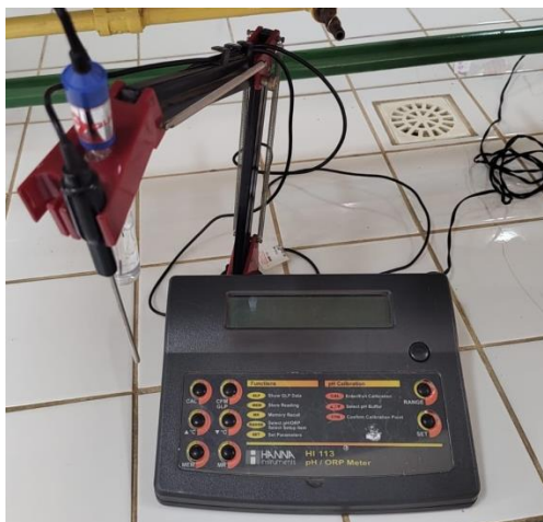
Figura 23: Medidor de potencial hidrogeniônico HANNA
