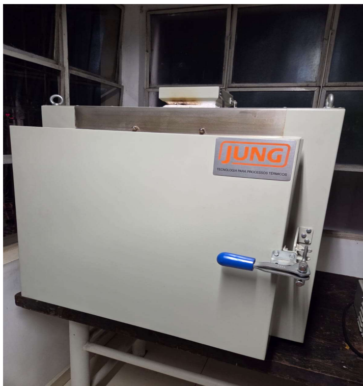
Figura 5 – Forno JUNG para a realização de tratamentos térmicos
