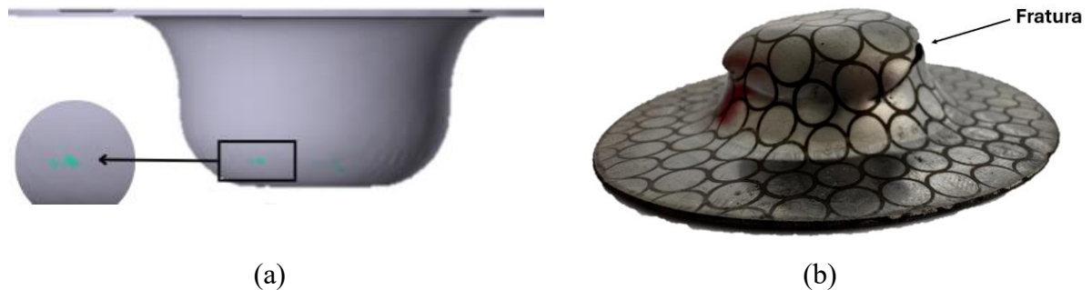
Figura 45 – Identificação do local da fratura.
