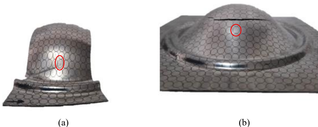
Figura 42– Blanks 60 mm e 180 mm de Largura fraturados do Nakazima .
