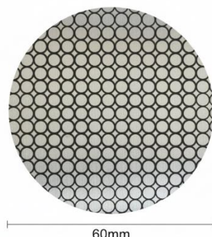
Figura 30- Ilustração do blank de 60 mm de diâmetro utilizado na estampagem
