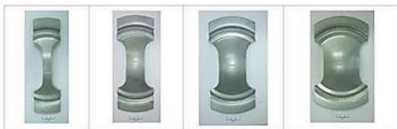
Figura 10– Aspectos das tiras metálicas no levantamento da CLC.
