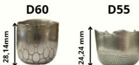
Figura 38- Imagem dos copos de Aço AISI 430 com diâmetro de 55 e 60 mm estampados pela estampagem por embutimento.
