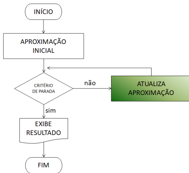
Figura 6.3: Algoritmo geral para o cálculo de zeros de funções.
