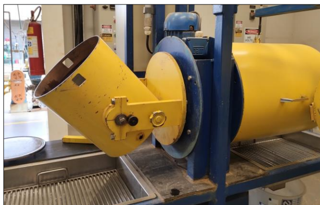
Figura 8: Moinho de bolas empregado na cominuição de parte do rejeito da flotação industrial.
