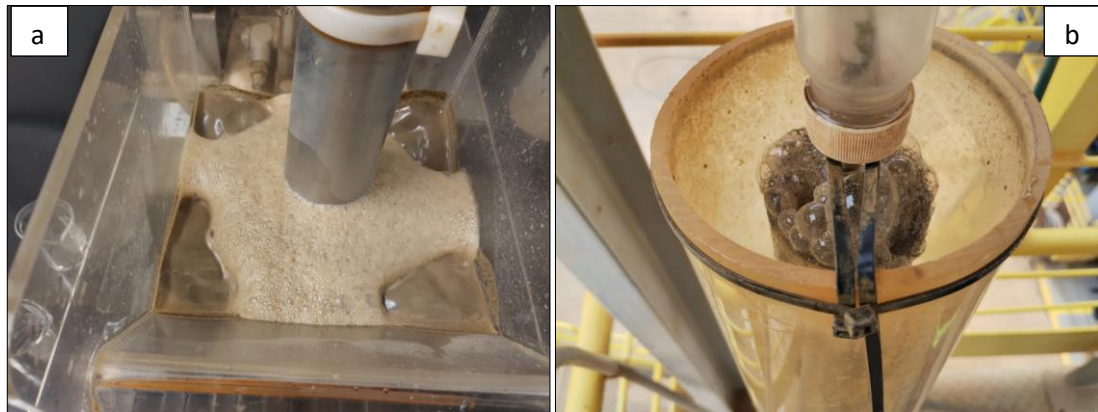
Figura 16: Em (a) Condicionamento da polpa para realização da flotação de bancada. Em (b) transbordo do flotado na coluna de flotação.
