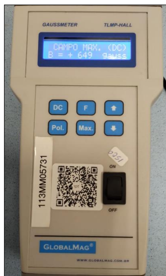
Figura 10: Gaussmeter empregado para a terminação do campo magnético do ímã de mão utilizado na separação magnética de baixo campo.
