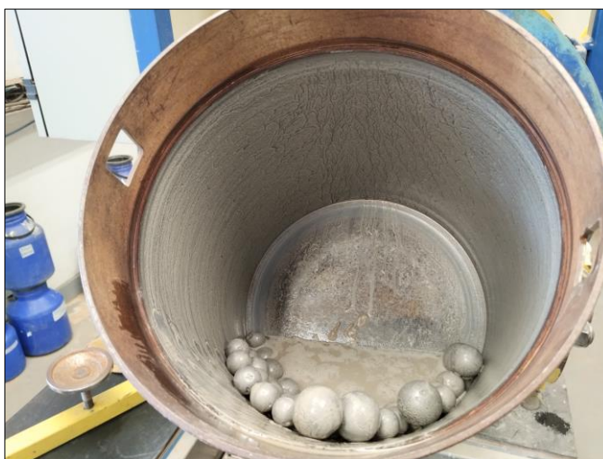
Figura 9: Vista interna do moinho de bolas utilizado na cominuição de parte do rejeito industrial.
