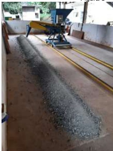
Figura 8 – Preparação de amostra em Stacker.
