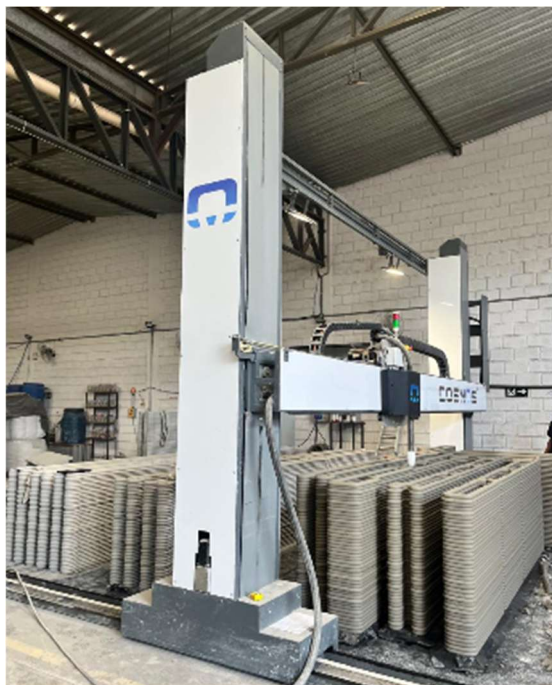
Figura 5 -- : Impressora 3d de concreto
