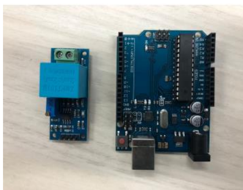
Figura 29 - Sensor de Tensão AC ZMPT101B 0-250V e Microprocessador Arduino UNO
