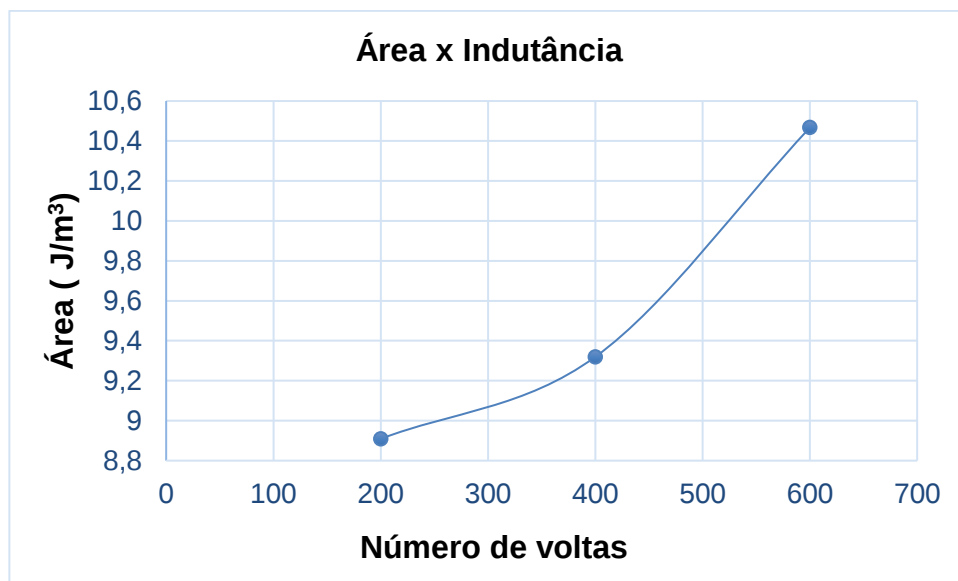
Figura 48 - Área em função de número de voltas no indutor secundário para a mesma frequência de 20 Hz
