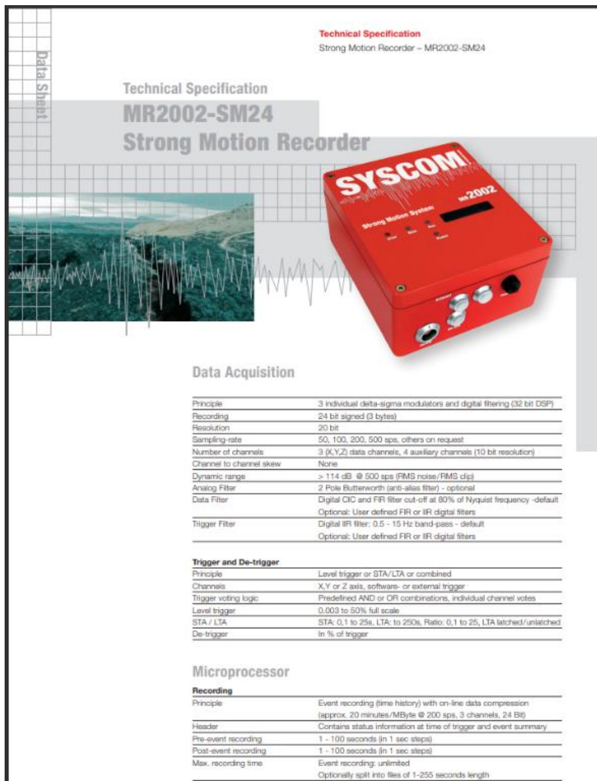
Figura 130 – Especificações: SYSCOM:MR2002-SM24 – Parte 1.
