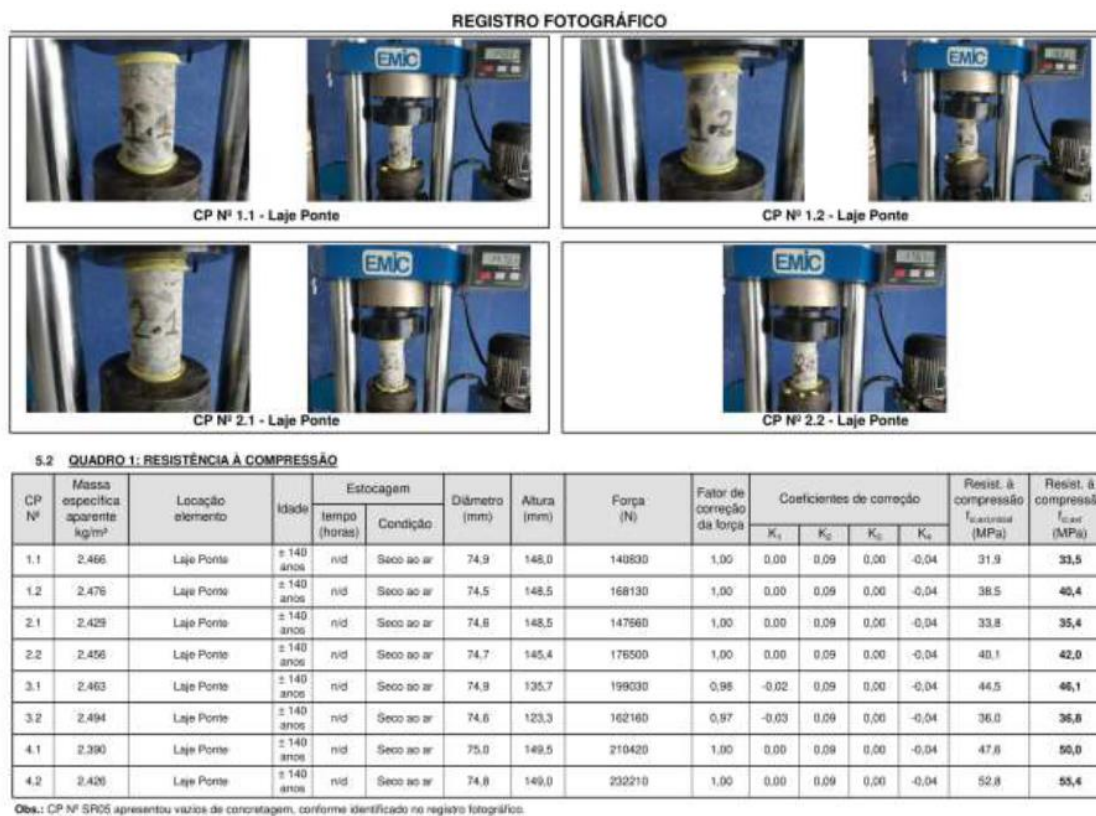
Figura 61 – Ensaio de Compressão Axial 2/2.
