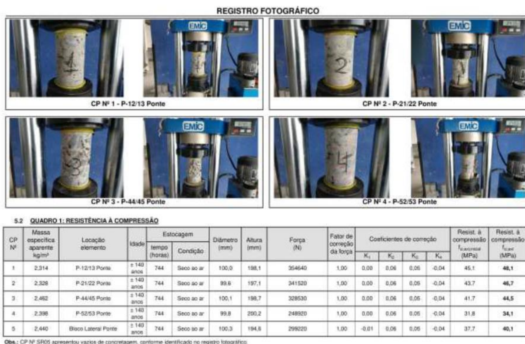
Figura 60 – Ensaio de Compressão Axial 1/2.
