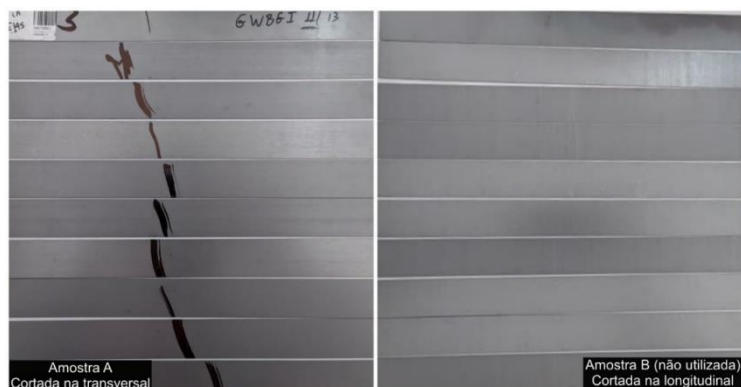
Figura A. 1 - Grupo 1 (Amostra A) - Aço GNO M350-50A
