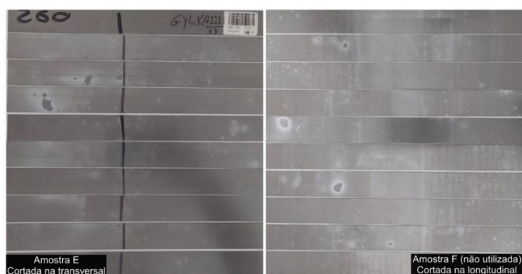
Figura A. 3 - Grupo 3 (Amostra E) - Aço GNO M530-54A
