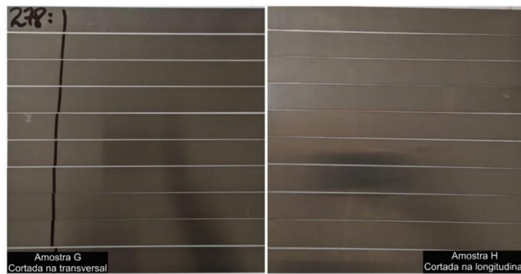
Figura A. 4 - Grupo 4 (Amostras G e H) - Aço GNO M530-54A
