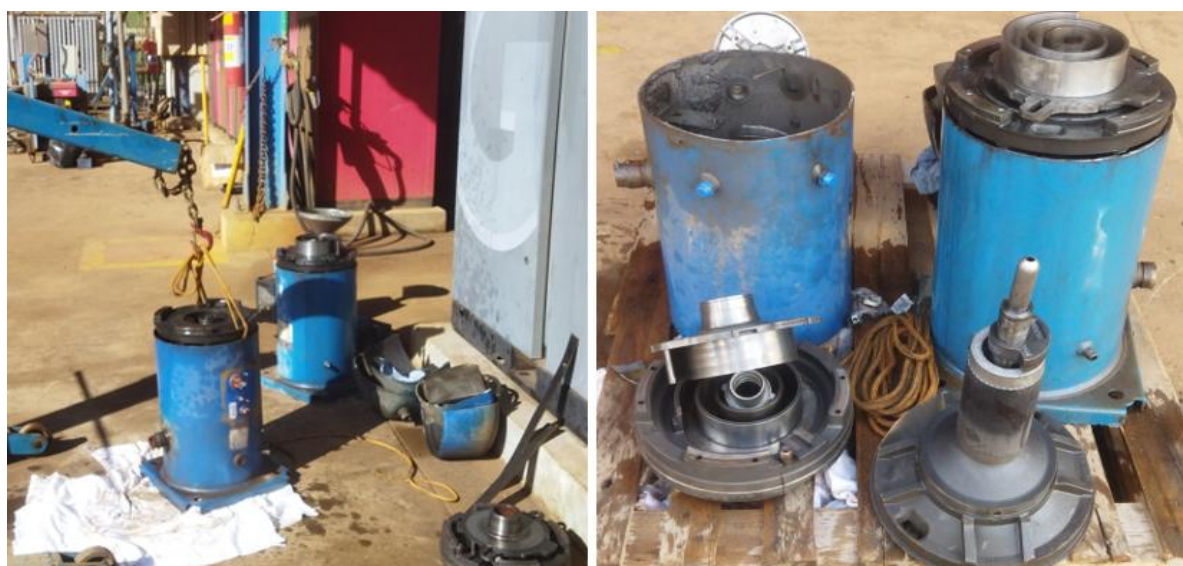
Figura 2 - Investigação das quebras dos compressores
