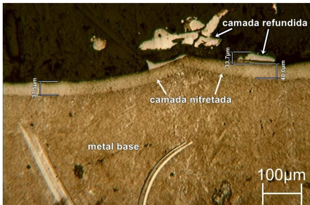
Figura 38 - Micrografia da amostra usinada com eletrodo de grafita, amostra 9, desbaste ( T_{on}500\mu s , corrente 40A) seguido de acabamento ( T_{on}50\mu s , corrente 10A) e T_{off} de 5.
