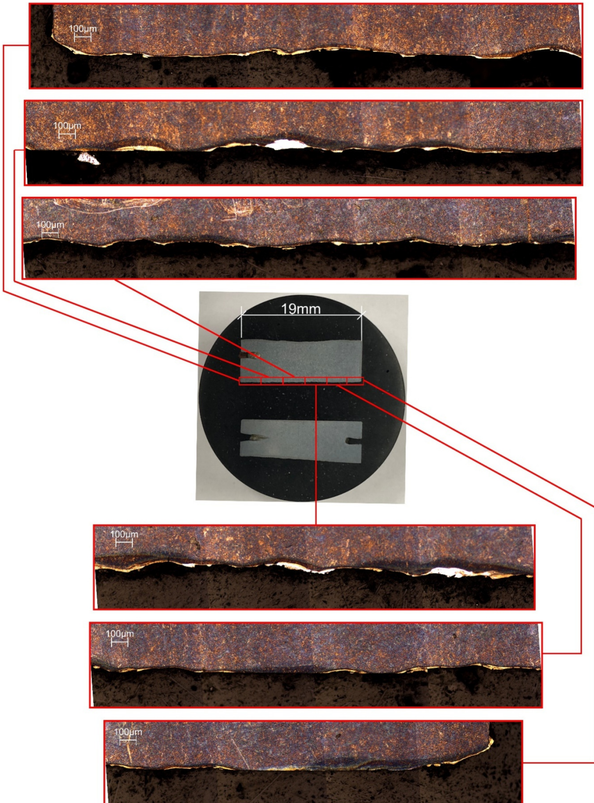
Figura 44 – Micrografia da secção transversal da amostra 16 usinada com eletrodo de grafita e após a retirada de 50µm com polimento ( T_{on}10\mu s , e T_{off} 1 e corrente 40A).
