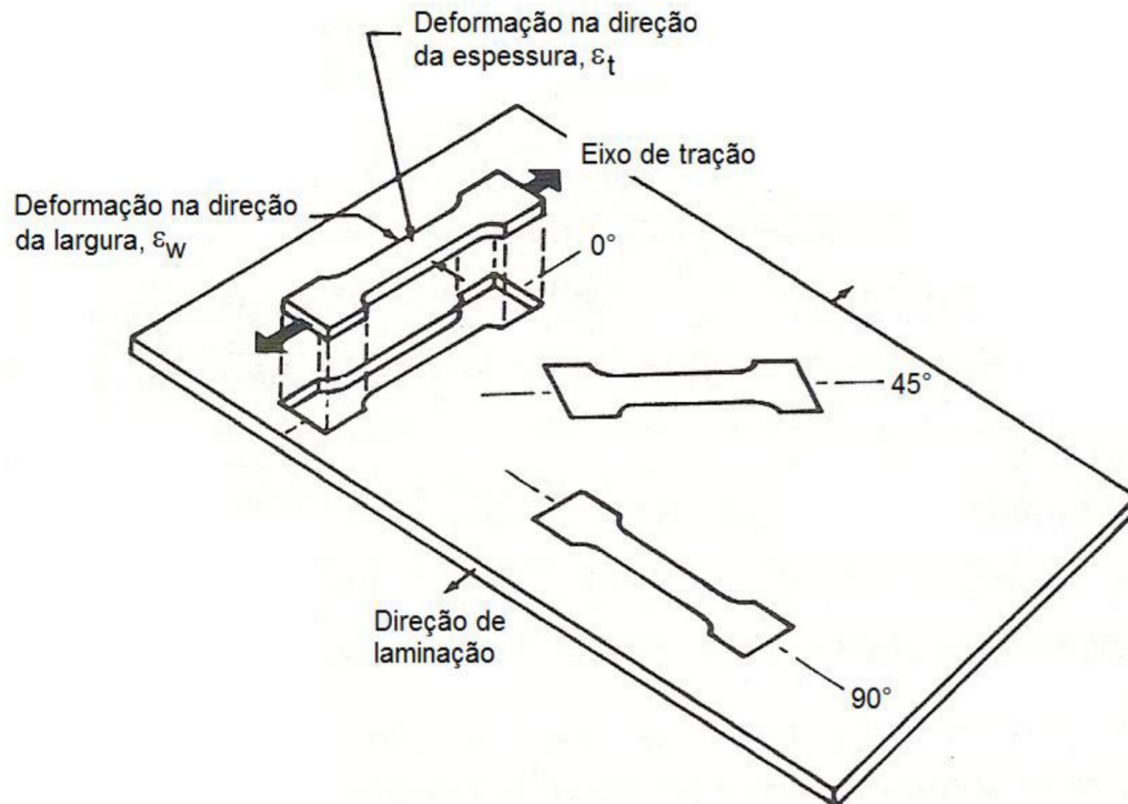
Figura 3.27 - Representação esquemática da retirada de corpos de prova de tração para cálculo dos coeficientes de anisotropia.
