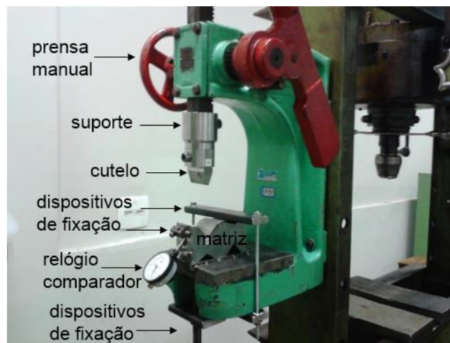
Figura 4.11 - Sistema de dobramento utilizado contemplando os componentes e dispositivo para realização dos ensaios.
