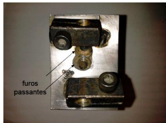
Figura 4.16 - Matriz de dobramento com adaptação para fixação do relógio comparador.
