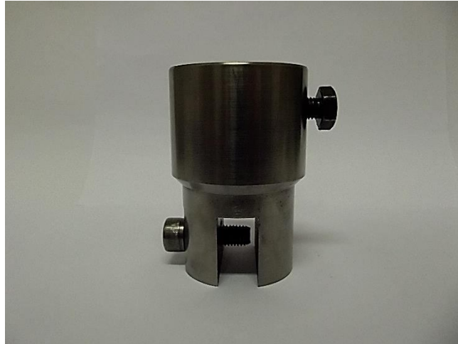
Figura 4.13 - Suporte de fixação dos cutelos de dobramento à prensa.
