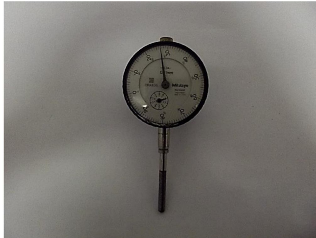
Figura 4.15 - Relógio comparador utilizado para o controle da posição dos corpos de prova.
