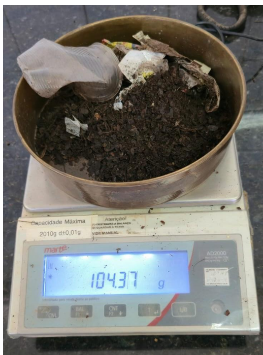
Figura 23- Medição gravimétrica do material interceptado pela Gaiola 1 no dia 28 de dezembro.
