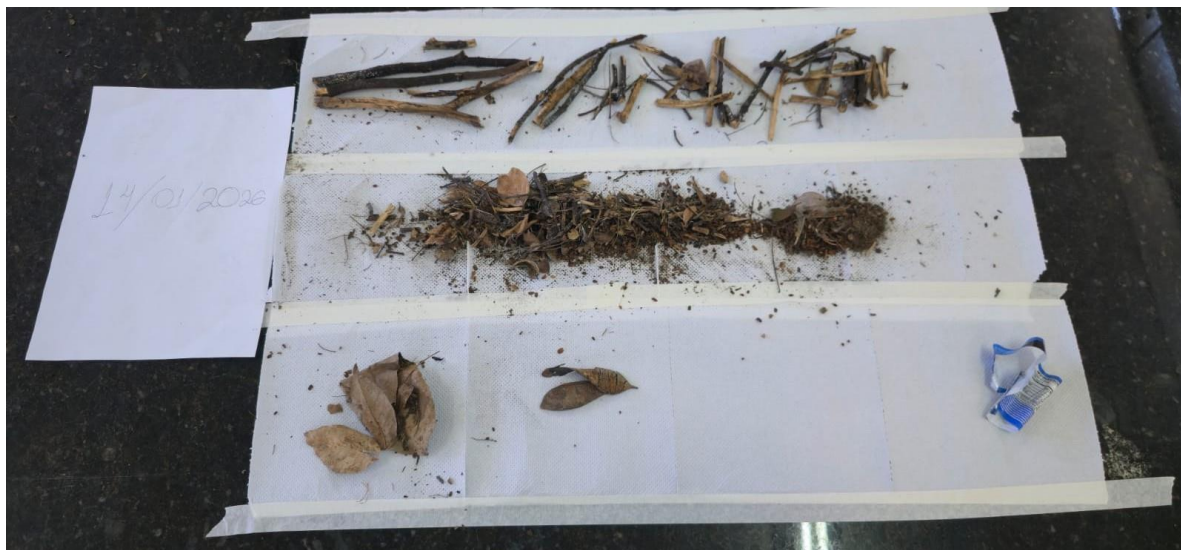
Figura 34- Triagem manual e caracterização visual qualitativa das amostras retidas na Gaiola 2 (14/01)
