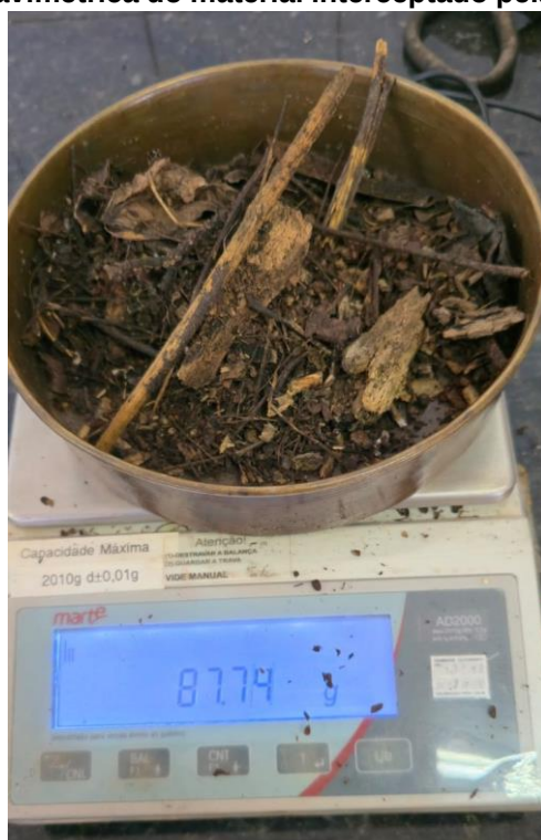
Figura 24- Medição gravimétrica do material interceptado pela Gaiola 1 no dia 31 de janeiro
