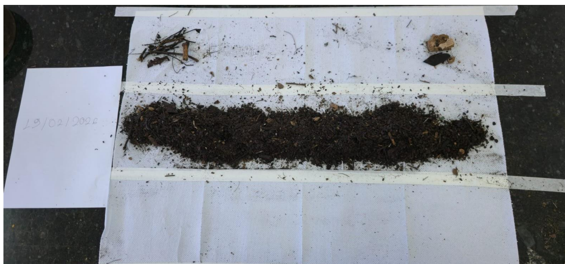
Figura 44- Triagem manual e caracterização visual qualitativa das amostras retidas fundo do bueiro(19/02
