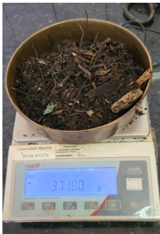
Figura 40- Registo gravimétrico das amostras de material depositado no fundo do bueiro(19/02)
