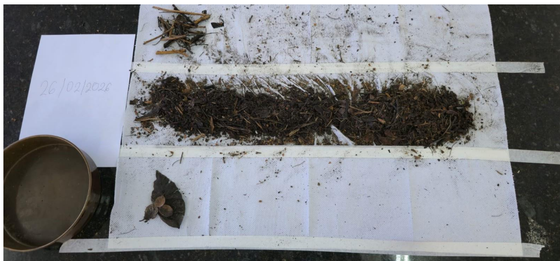
Figura 45- Triagem manual e caracterização visual qualitativa das amostras retidas fundo do bueiro(26/02)
