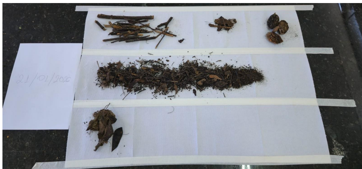
Figura 35- Triagem manual e caracterização visual qualitativa das amostras retidas na Gaiola 2 (21/01)
