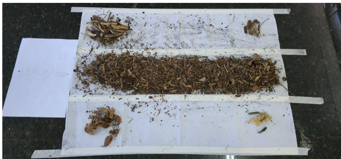
Figura 46- Triagem manual e caracterização visual qualitativa das amostras retidas fundo do bueiro(18/04)
