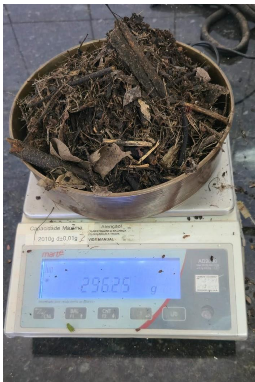
Figura 30- Medição gravimétrica de 31/Jan coletada na Gaiola 2.
