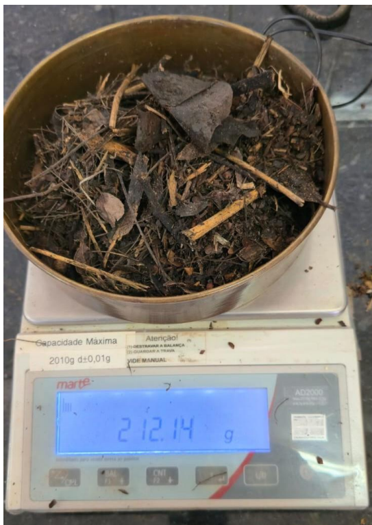
Figura 41- Registo gravimétrico das amostras de material depositado no fundo do bueiro(26/02)
