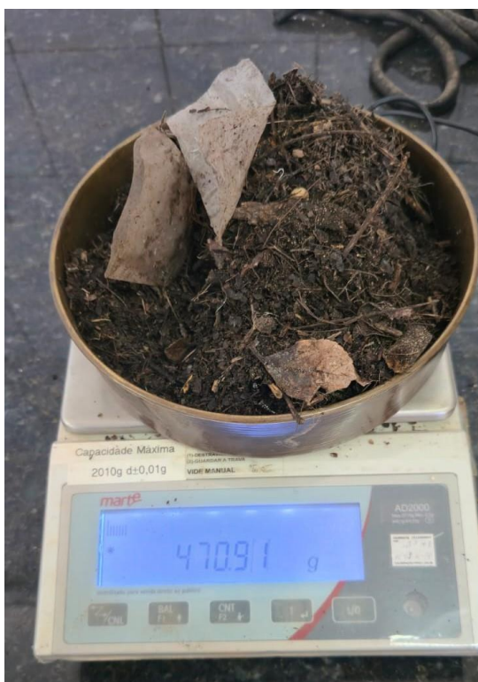
Figura 39- Registro gravimétrico das amostras de material depositado no fundo do bueiro(31/01).
