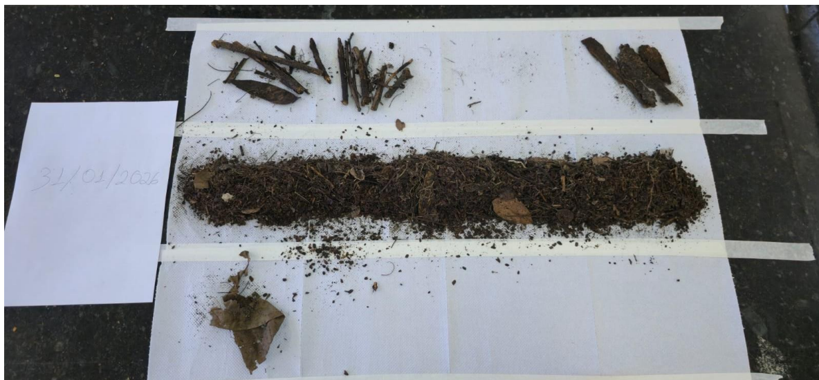
Figura 36- Triagem manual e caracterização visual qualitativa das amostras retidas na Gaiola 2 (31/01)
