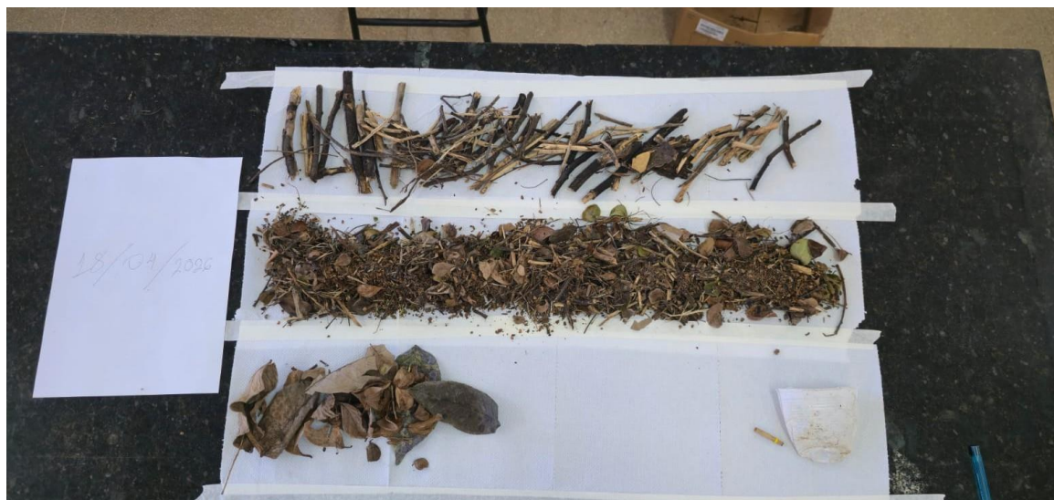
Figura 38- Triagem manual e caracterização visual qualitativa das amostras retidas na Gaiola 2 (18/04)
