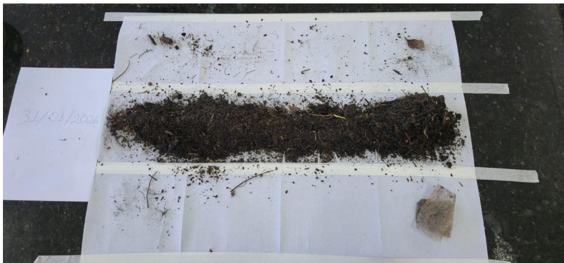
Figura 43- Triagem manual e caracterização visual qualitativa das amostras retidas fundo do bueiro(31/01).
