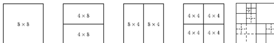
Figura 2.3 – Exemplo de particionamento de blocos em H.265/HEVC. O padrão HEVC permite particionamentos ainda mais flexíveis, como quadrees, adaptando-se melhor à complexidade espacial das imagens e otimizando a eficiência da compressão. Fonte: Autor.
