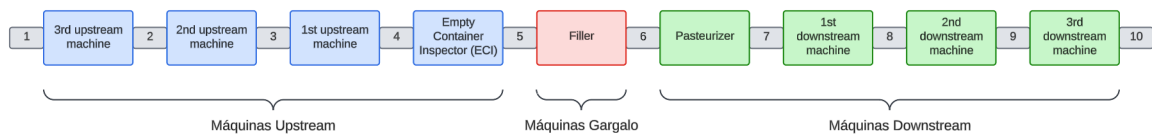
Figura 3.2 – Estrutura de uma linha de envase.
