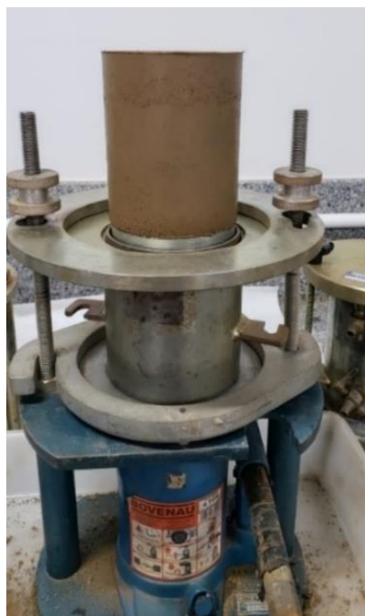
Figura 11: Corpo de prova sendo desmoldado durante o ensaio de compactação
