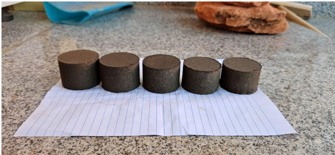
Figura 212: Corpos de prova obtidos após realização de ensaio Mini MCV
