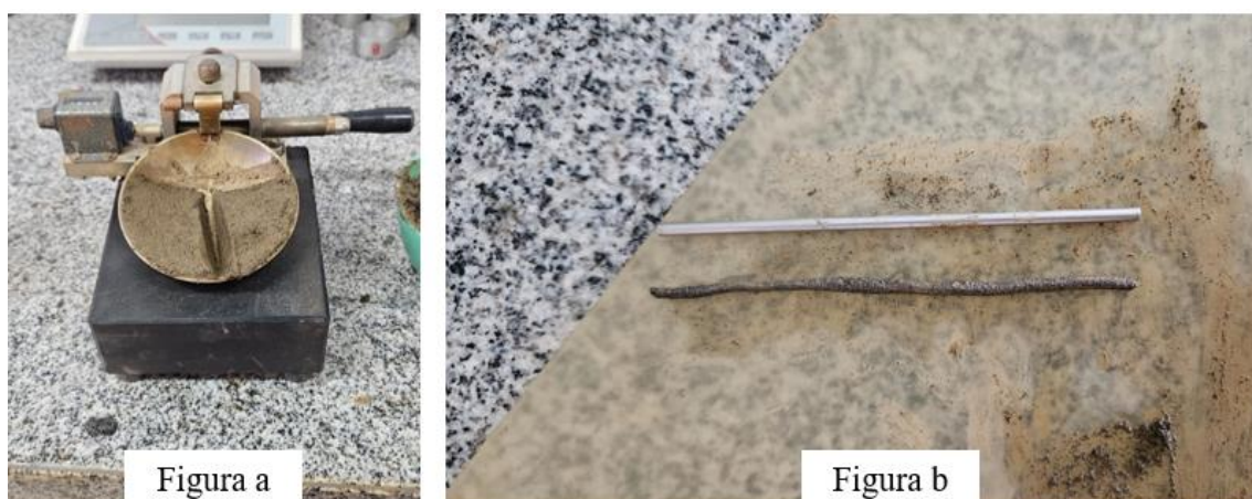
Figura a: Ensaio de limite de liquidez; Figura b: Ensaio de limite de plasticidade
