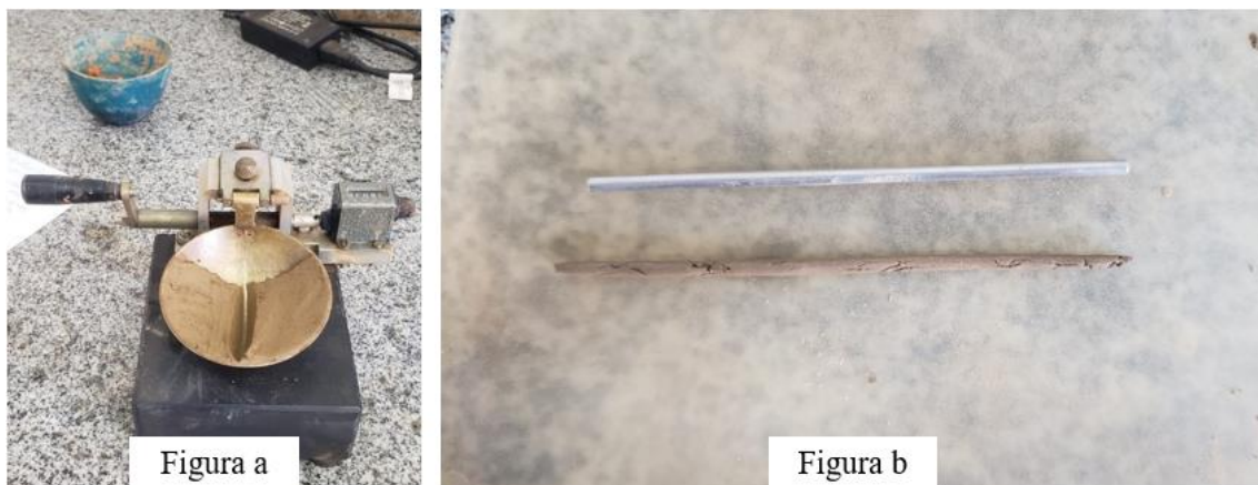
Figura a: Ensaio de limite de liquidez; Figura b: Ensaio de limite de plasticidade
