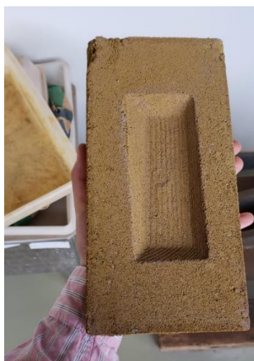
Figura 2: Tijolos de solo-cimento maciço
