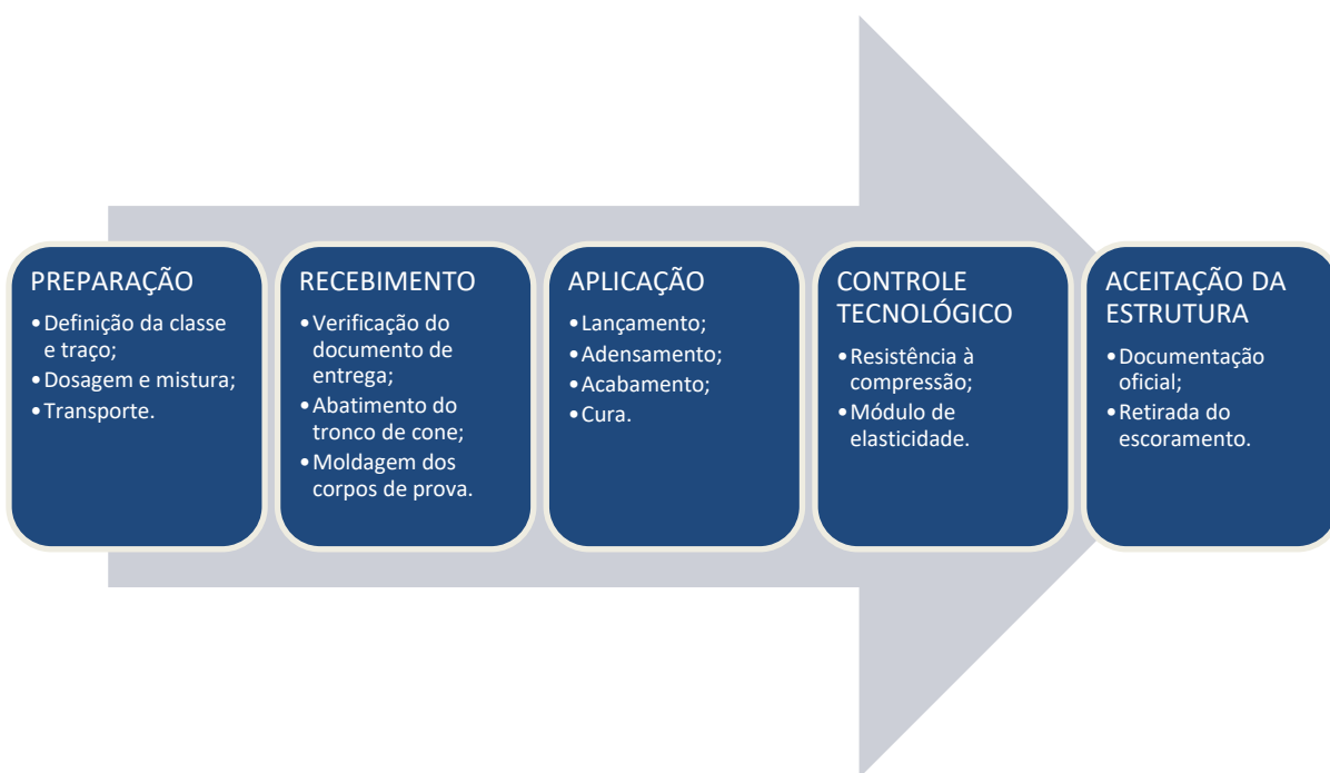
Figura 4 – Fluxograma dos processos da concretagem
