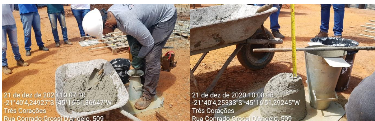
Figura 31 – Ensaio de abatimento de tronco de cone
