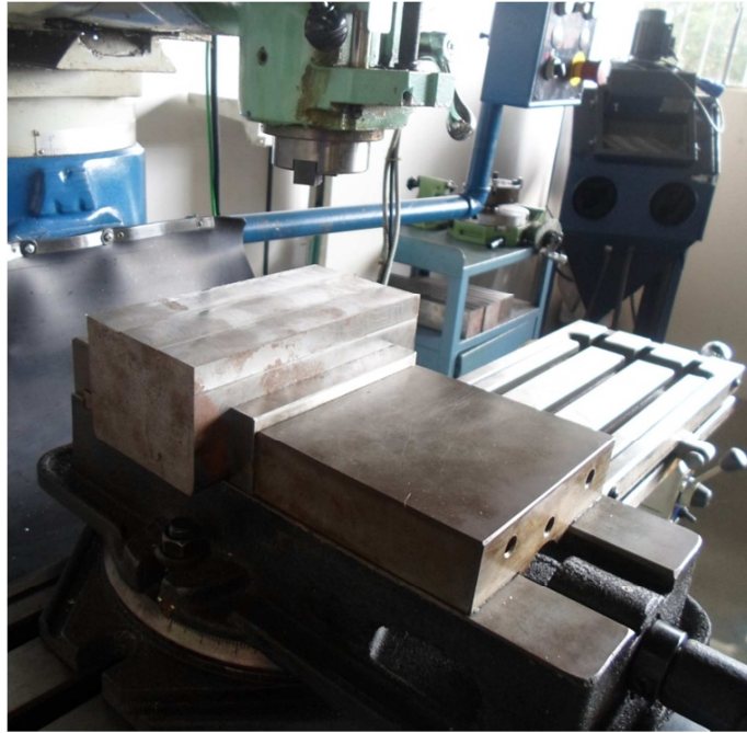
Figura 29 – Corpo de prova fixado na mesa da fresadora.
