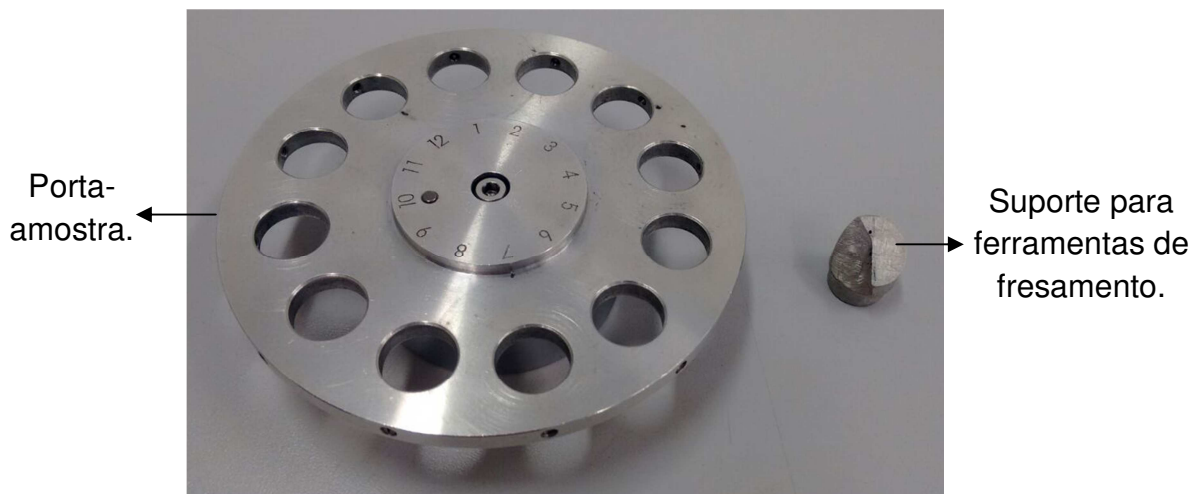
Figura 43– Porta-amostra e suporte pra ferramentas de fresamento utilizados no MEV.
