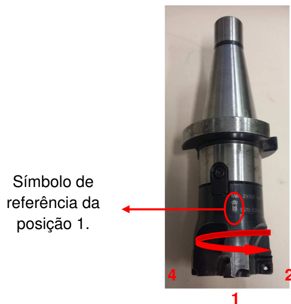
Figura 41 – Posições ocupadas pelas ferramentas de corte na fresa.
