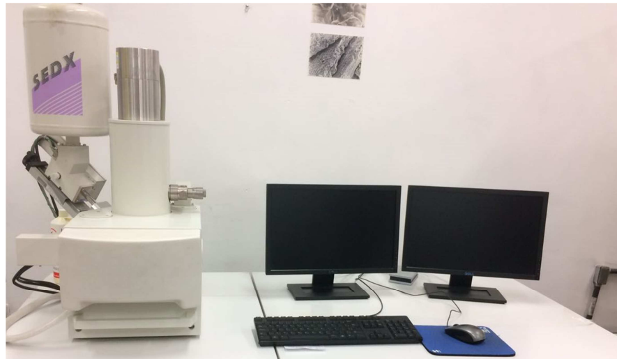
Figura 35 – Microscópio eletrônico de varredura Shimadzu SSX-550.
