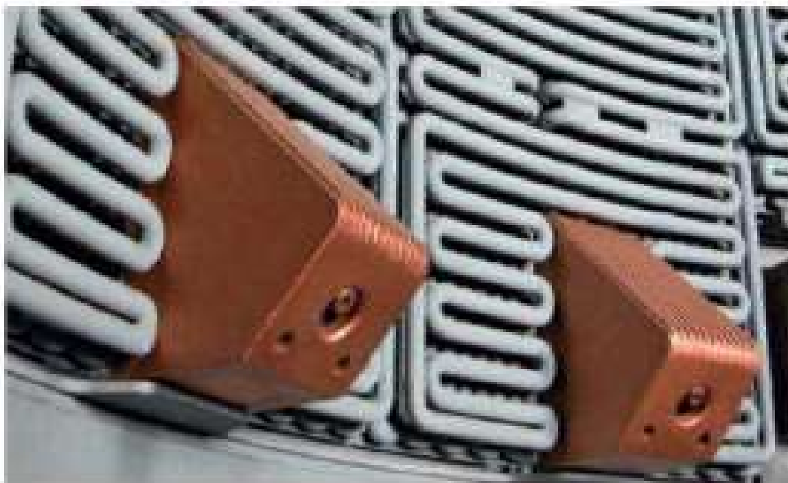
Figura 23 - Parede com painel tubular Fonte: Silva (2014)
