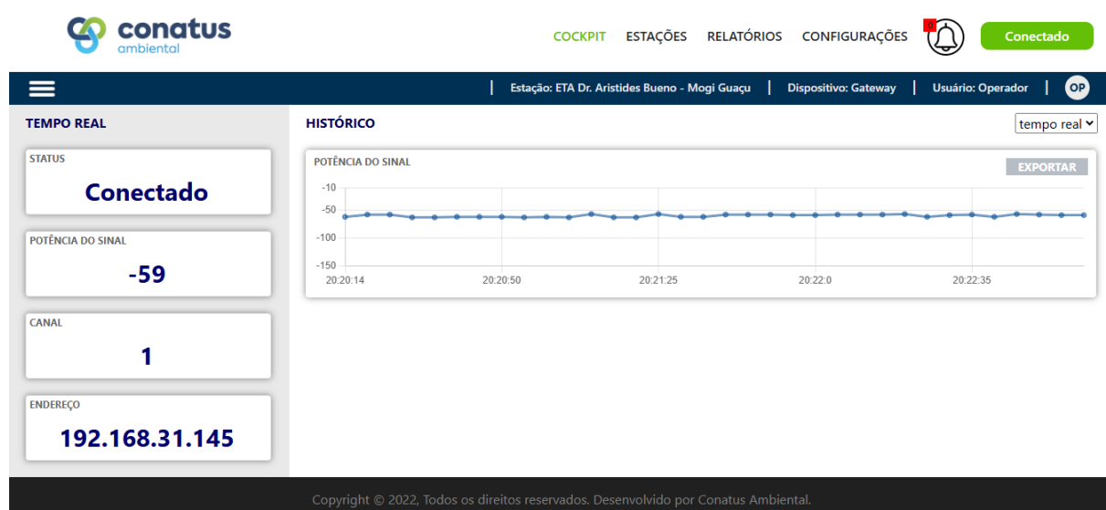
Figura 4.6 – Interface de comunicação para telemetria dos parâmetros do gateway , instalado na ETA Aristides Bueno, Mogi Guaçu/SP.
