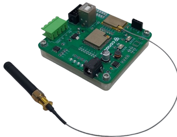
Figura 4.1 – Placa do hardware introduzido na Seção 3.1 para atuação como node ou gateway .
