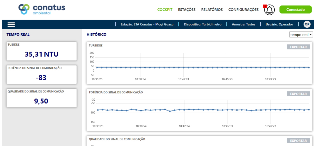
Figura 4.5 – Imagem parcial da interface de comunicação para telemetria dos parâmetros do turbidímetro de terceiros, utilizados nos testes em ambiente controlado na Conatus, Mogi Guaçu/SP.
