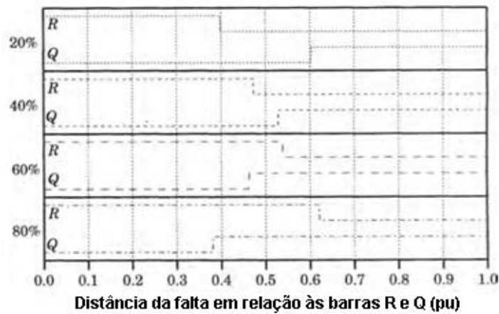
Figura 3.10 - Condução do varistor em função da localização da falta e ao nível de compensação. Fonte: Adaptado de (ANDERSON, 1999).
