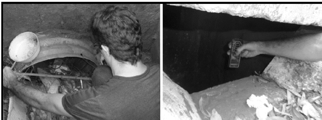
Figura 39 - Medições com fita métrica convencional e a laser.
