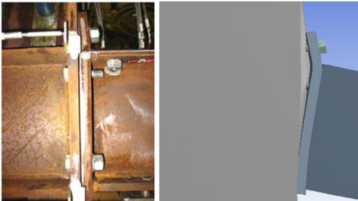
Figura 67: Comparação entre análises práticas e numéricas para o modelo C19-P16 – Do próprio autor
