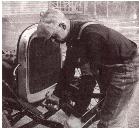
Figura 4: Partida a manivela nos veículos a combustão Fonte: Autoentusiastas, 2014
