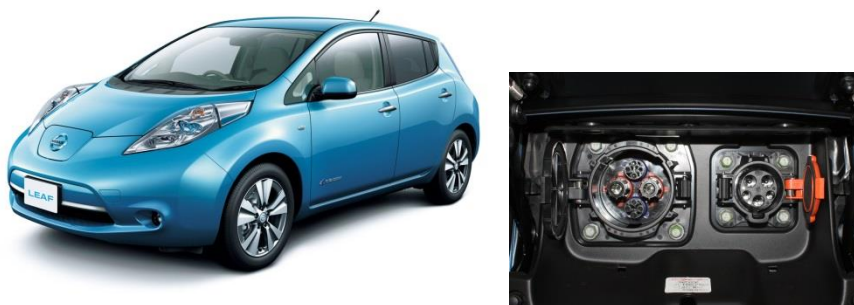
Figura 15: Nissan Leaf e detalhe dos conectores de carregamento rápido e lento Fonte: Martins e Brito, 2011
