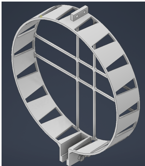
Figura 3.10 – Suporte e proteção para motores e hélices.
