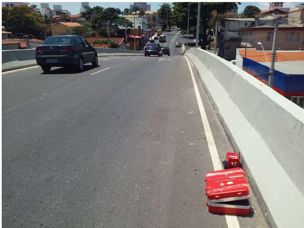
Figura 16: Acelerômetro Syscom registrando as acelerações.
