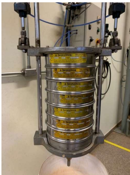
Figura 18 – Peneirador utilizado para determinação da distribuição granulométrica
