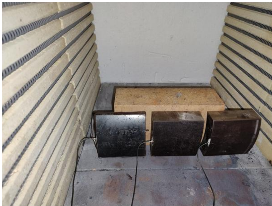
Figura 10 - Posição de montagem das amostras no interior.
