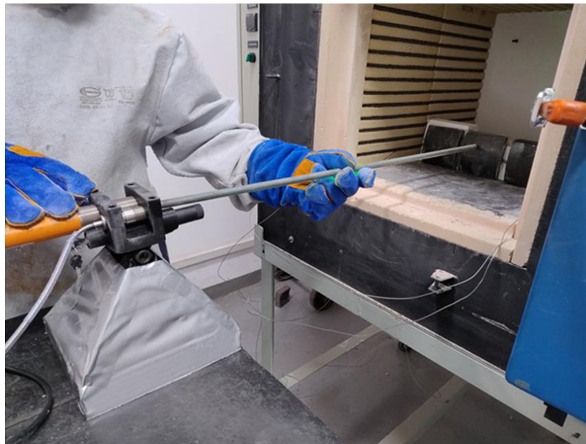
Figura 13 - Distância entre o pirômetro e as amostras.
