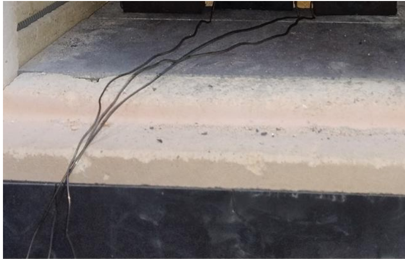
Figura 11 - Local correto para a passagem dos fios do termopar.
