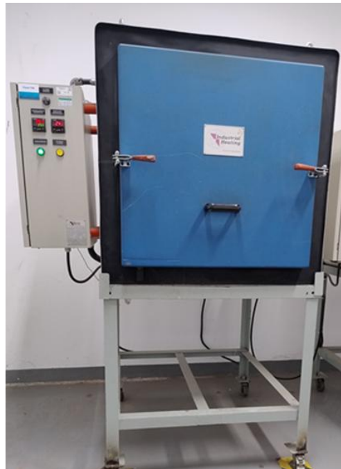
Figura 1 – Forno elétrico utilizado nos experimentos.
