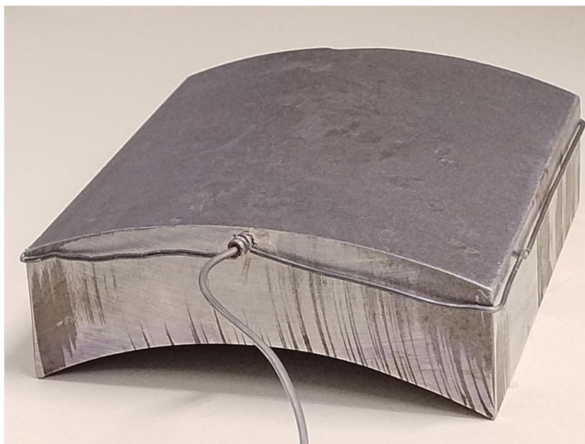
Figura 9 - Montagem da amostra com o termopar.
