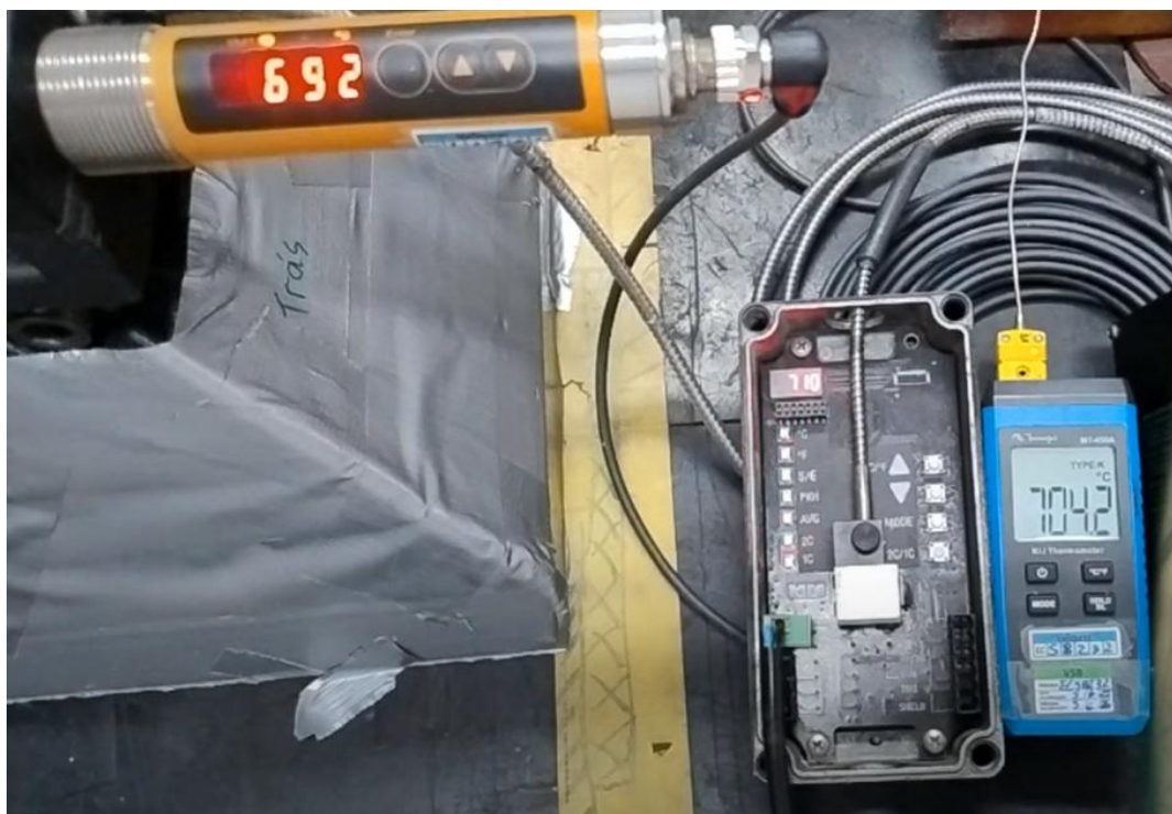
Figura 17 - Registros de temperatura dos pirômetros e do termopar.
