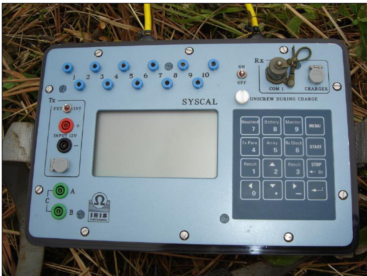
Figura 4-3: Syscal Switch Pro - Eletorresistivímetro digital multi-eletrodo utilizado durante a aquisição. Fonte: Autor (2023).
