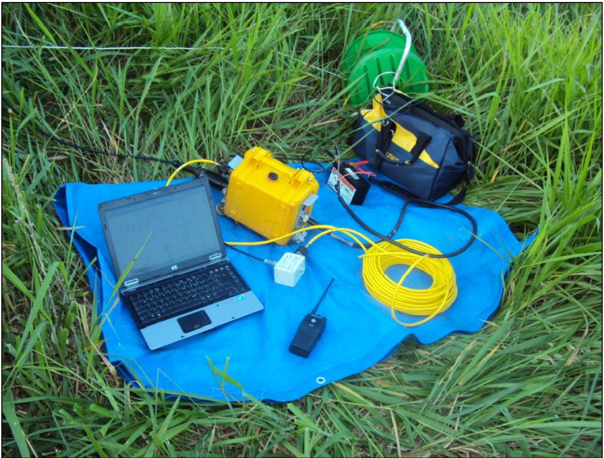
Figura 4-6: Sismógrafo GEODE e notebook utilizados nos trabalhos. A tela do computador apresenta o software que controla e gerencia a coleta dos dados sísmicos, permitindo o controle de qualidade. Fonte: Autor (2023).
