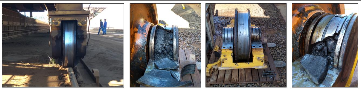
Figura 2-5: Fotos com evidências das falhas dos trucks da Empilhadeira (Stacker) mostrando rodas com bordas desgastadas e rolamentos quebrados prematuramente. Fonte: Autor (2024).
