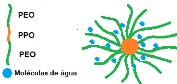
Figura 7: Representação da interação das micelas formadas a partir de pluronicos com moléculas de água.
