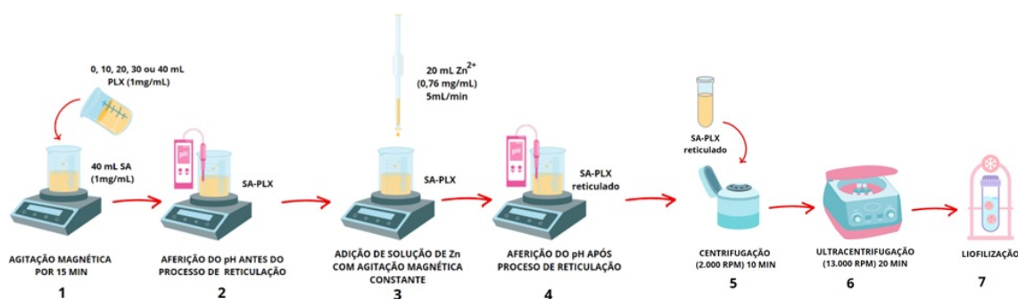
Figura 16: Esquema do procedimento para obtenção de nanopartículas de alginato e pluronic pelo método de gelificação ionotrópica com íons zinco.
