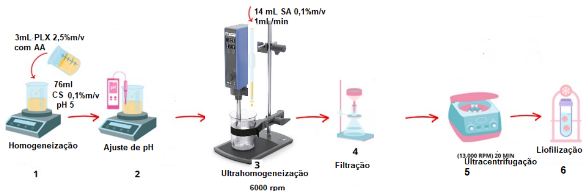
Figura 25: Esquema do procedimento para obtenção das nanopartículas de PLX com o ativo AA e revestidas pelo complexo polieletrólítico SA-CS
