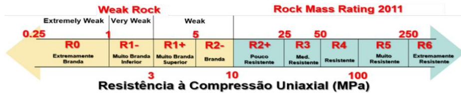
Figura 20 - Classificação Weak Rock (2020) e RMR (2011) em função da UCS
