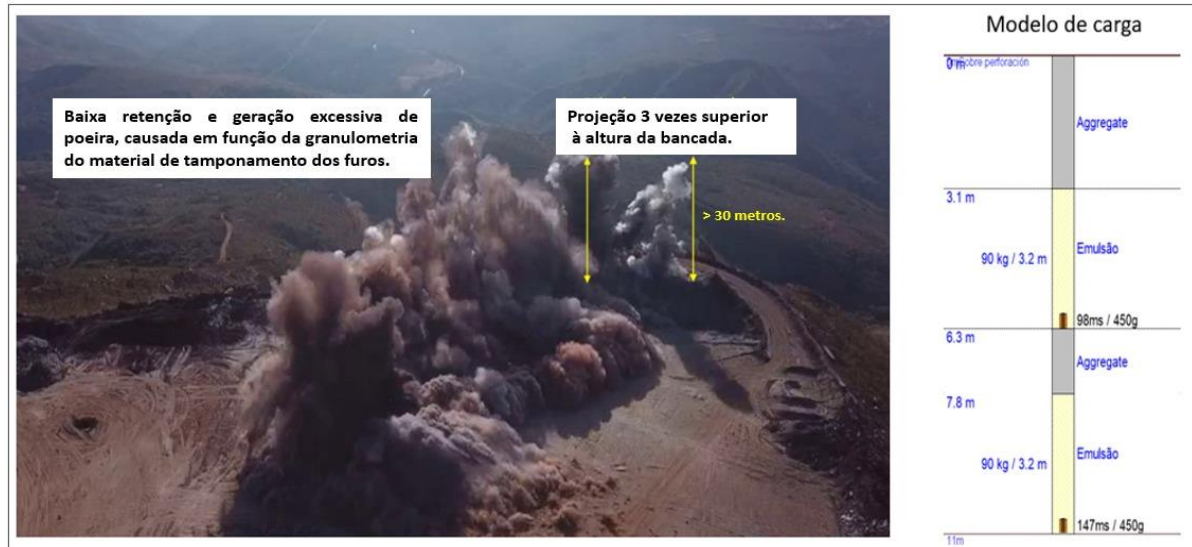
Figura 39 - Análise visual da detonação executada na bancada 1340 (Q-2)
