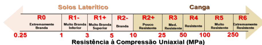
Figura 21 - Classificação de solos lateríticos e canga em função da UCS
