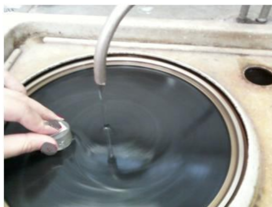
Figura 45 - Lixadeira de acabamento superficial
