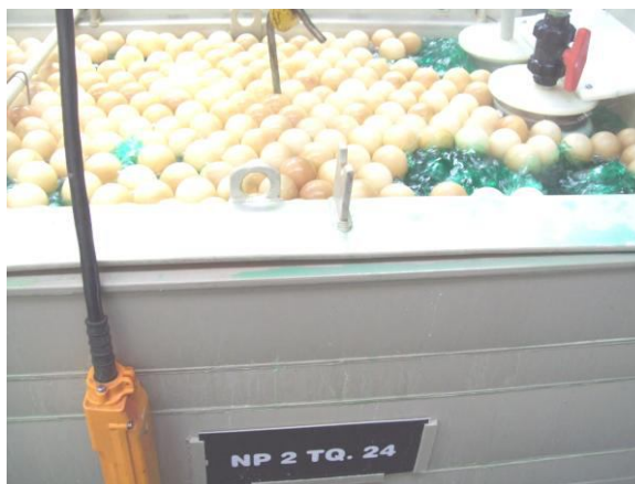
Figura 39 - Tanque de deposição de NP2, alto fósforo.
