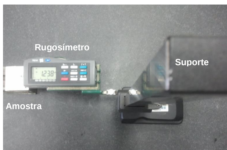
Figura 51 - Rugosímetro portátil PUC-MG/Contagem.
