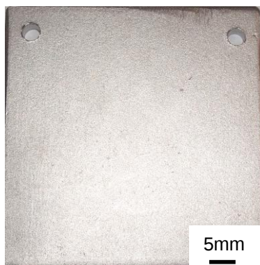
Figura 40 - Amostra NP2 após deposição química de NiP
