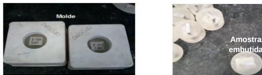
Figura 44 - a) Molde emborrachado, b) Amostras embutidas
