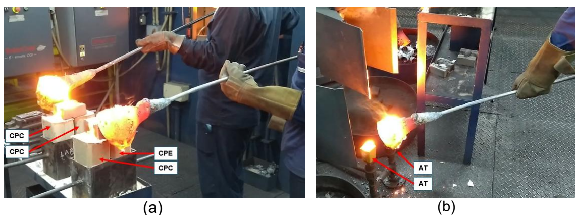
Figura 36 - Vazamento dos conjuntos de corpos de prova e análise térmica durante o experimento
