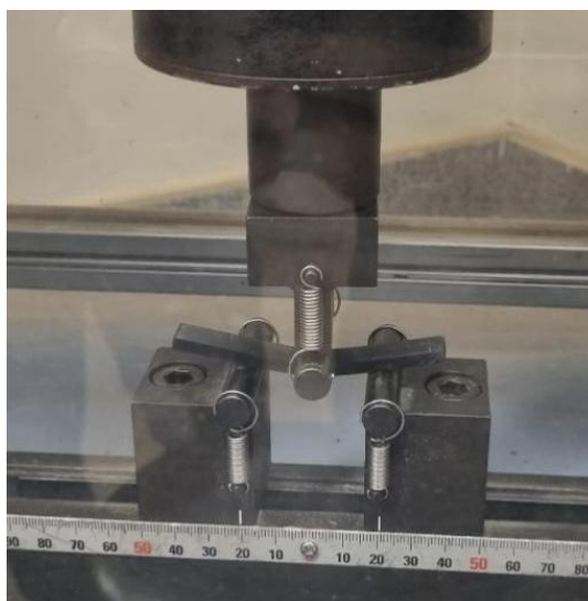
Figura 11 - Detalhe da máquina de universal de ensaios para o ensaio flexão 3 pontos dos nanocompósitos
