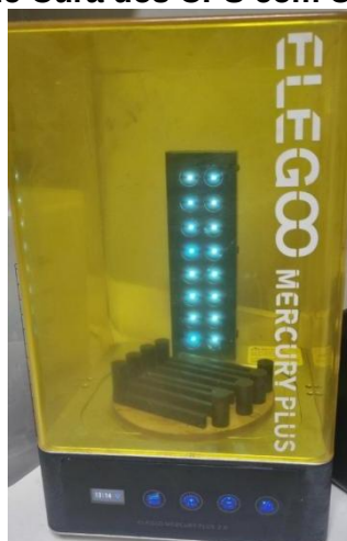
Figura 9 - Dispositivo de Cura dos CPS com UV ( \lambda = 405\text{nm} ) por 20 min
