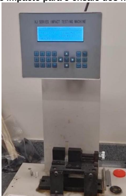
Figura 13 - Máquina de impacto para o ensaio dos nanocompósitos.
