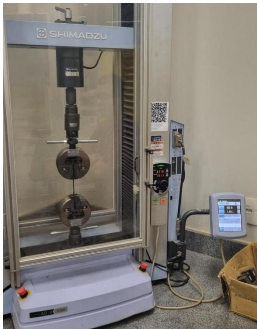
Figura 10 - Máquina de universal de ensaios para o ensaio de tração dos nanocompósitos.
