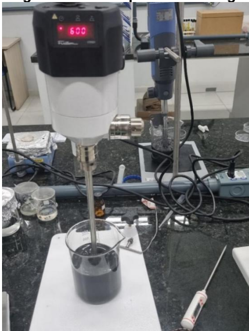
Figura 7 - Mistura do oligômero AESO por meio do agitador mecânico.
