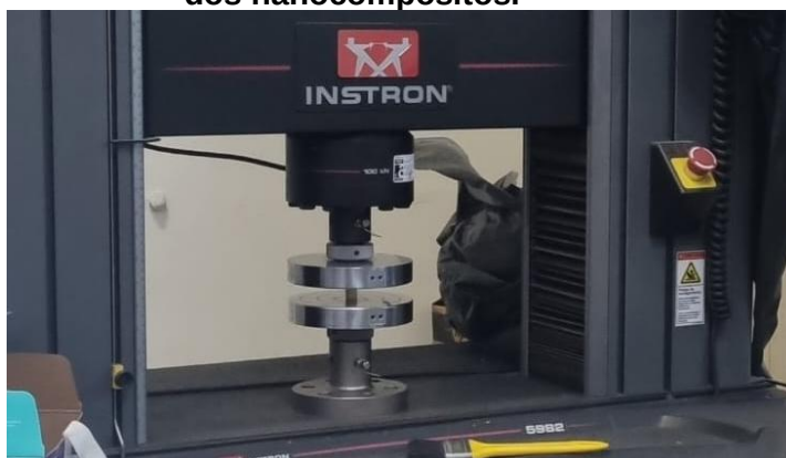
Figura 12 - Detalhe da máquina de universal de ensaios para o ensaio compressão dos nanocompósitos.
