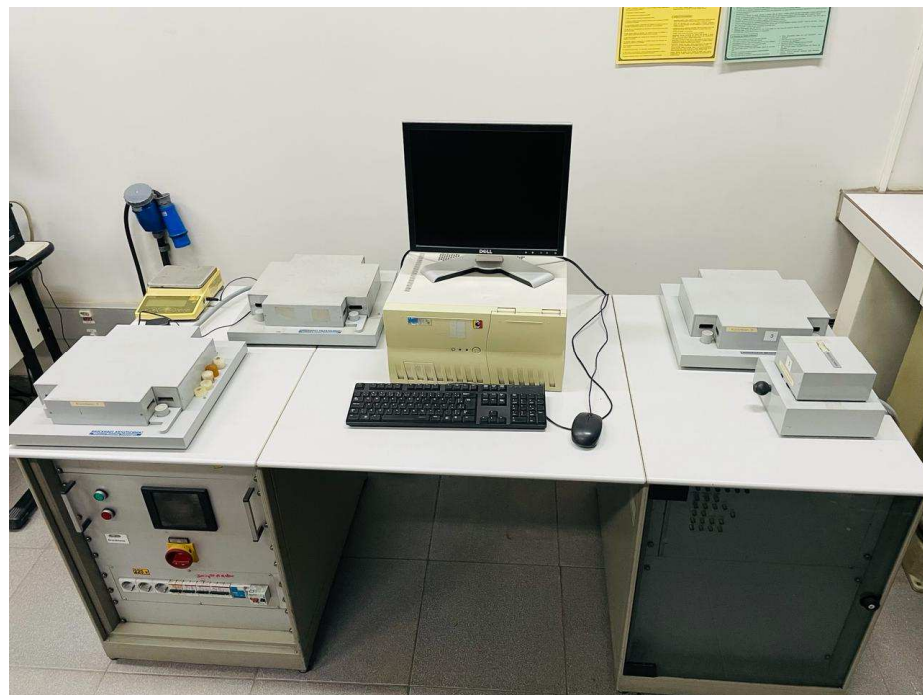
Figura 30 - Messtechnik modelo MPG100 com balança acoplada utilizado nas medições de perdas magnéticas.
