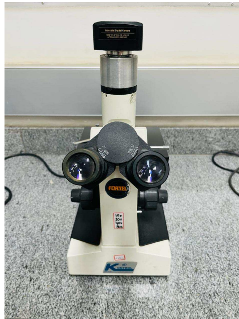
Figura 29 - Microscópio Óptico da marca Fortel utilizado para caracterização microestrutural das amostras.
