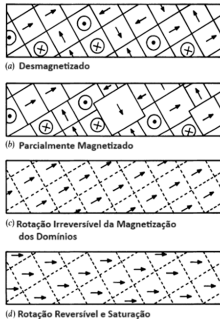
Figura 6 - Modificação da estrutura de domínios durante o processo de magnetização de um material ferromagnético. Passando pelo estágio (a) Desmagnetizado, (b) parcialmente magnetizado, (c) Rotação irreversível da magnetização dos domínios e à (d) Rotação e Saturação dos domínios.
