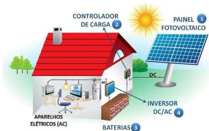
Figura 7: Componentes do Sistema Fotovoltaico
