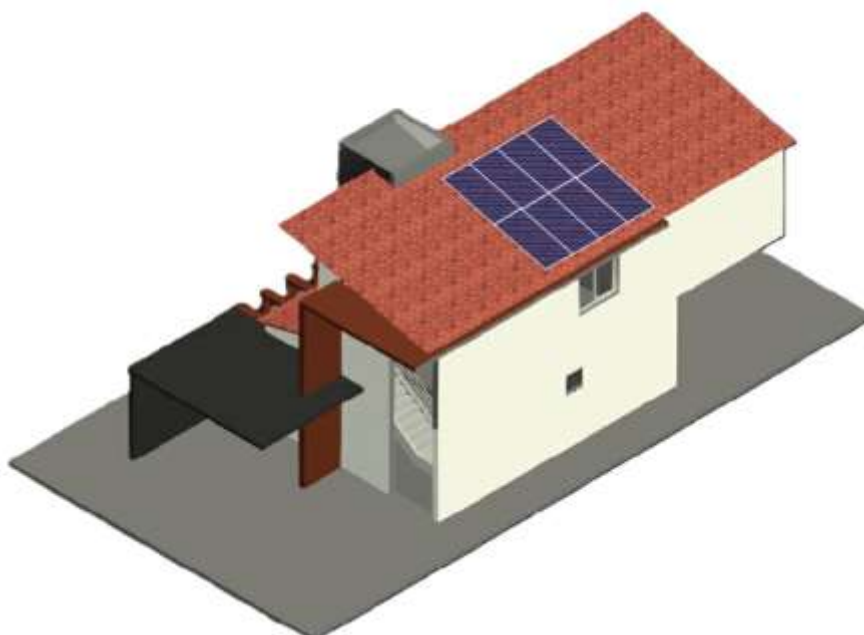
Figura 21: Disposição em duas fileiras dos módulos TSM-DE19-550 Wp/Trina Solar®
