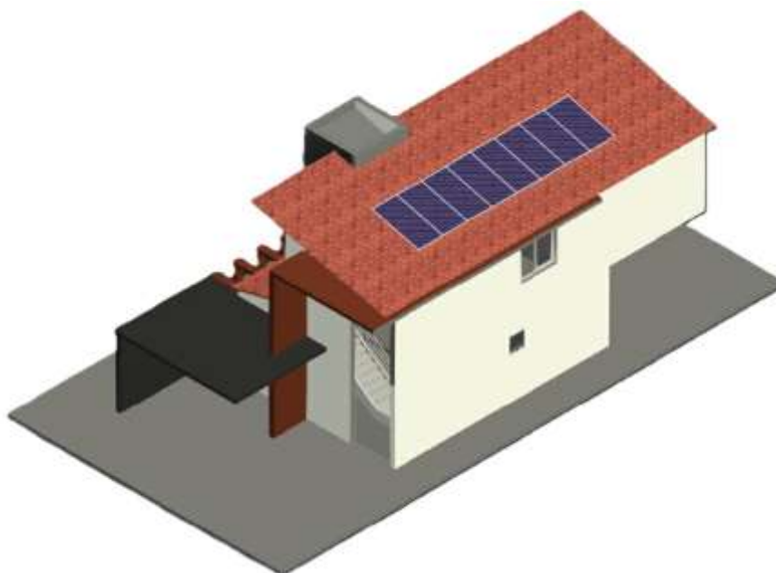
Figura 20: Disposição em uma fileira dos módulos TSM-DE19-550 Wp/Trina Solar®
