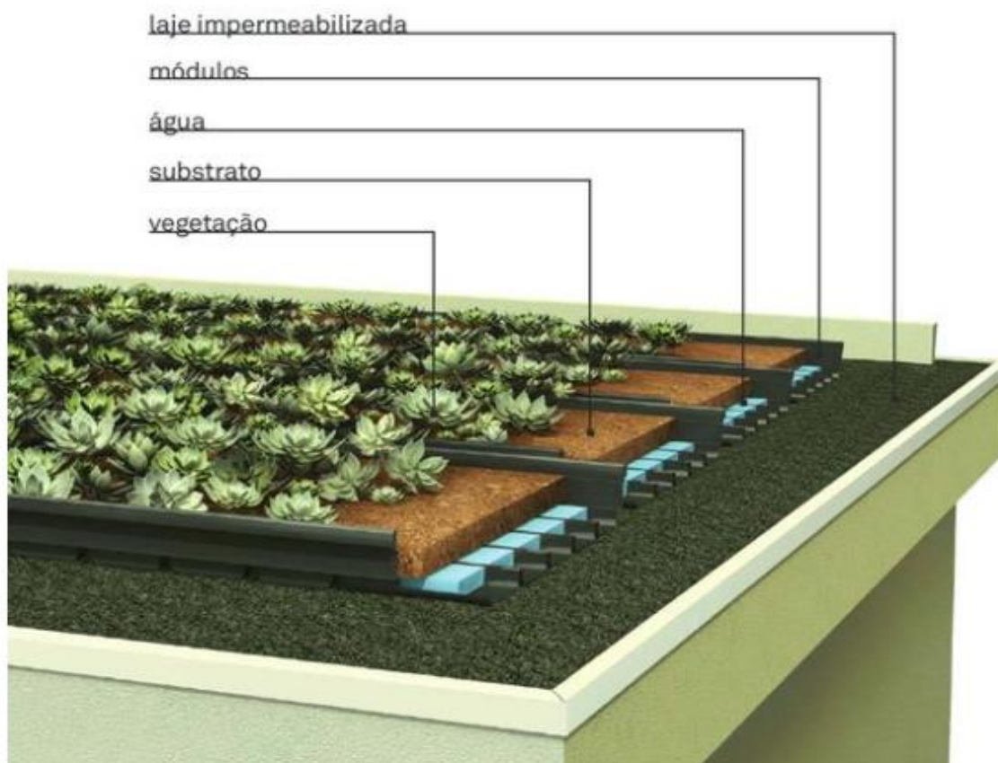
Figura 14 – Representação esquemática de um telhado verde.
