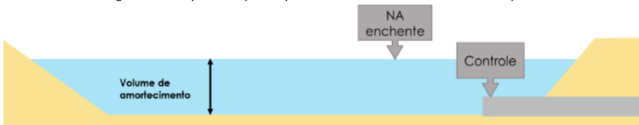
Figura 11 – Representação esquemática de um reservatório de detenção.
