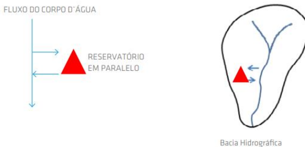
Figura 16 – Representação esquemática de um reservatório de retenção off-line.
