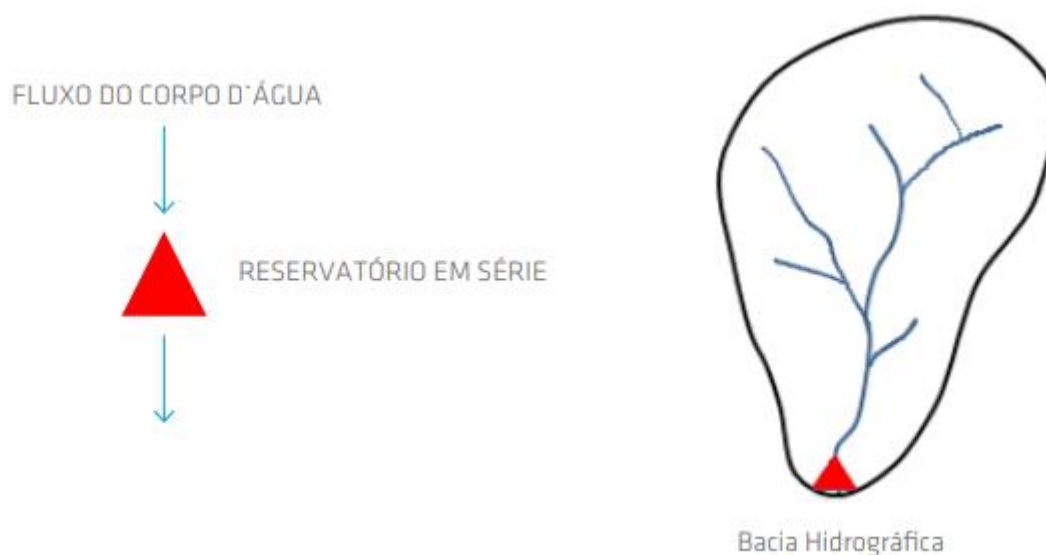
Figura 15 – Representação esquemática de um reservatório de retenção in-line.
