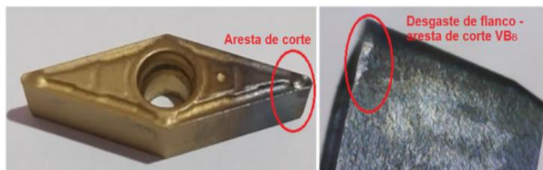
Figura 21 – Ilustração da ferramenta de corte VBMT110304-MV UE6020 e suas arestas de corte
