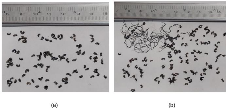
Figura 74 - Forma do cavaco do experimento 0,15-278, (a) 1º passe VB 0,184 mm e (b) 5º passe VB 0,239 mm - C45 +N
