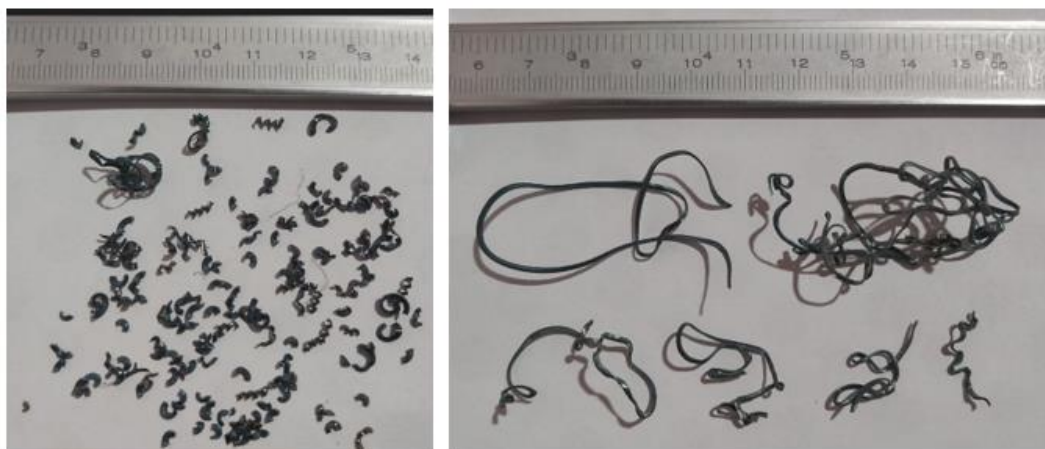
Figura 69 - Forma do cavaco do experimento 0,23-300, (a) 1º passe VB 0,173 mm e (b) 2º passe VB 0,300 mm - C45 +SR
