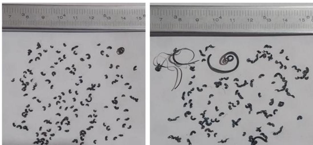
Figura 63 - Forma do cavaco do experimento 0,23-180, (a) 1º passe VB 0,020 mm e (b) 8º passe VB 0,086 mm - C45 +SR
