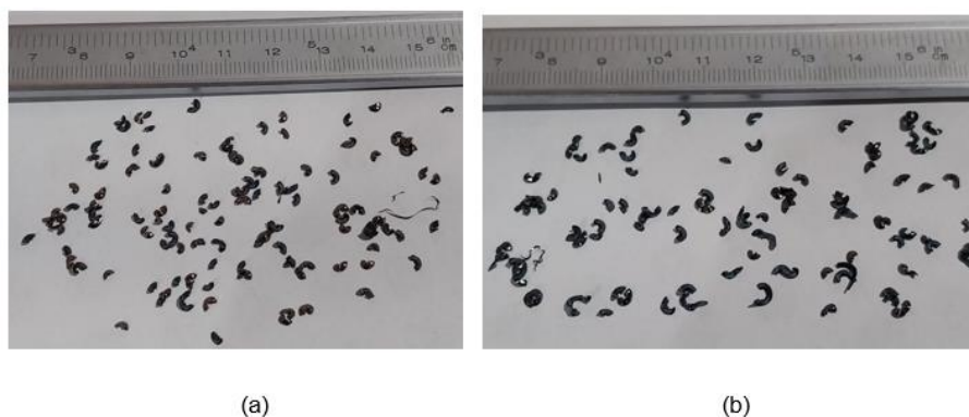
Figura 77 - Forma do cavaco do experimento 0,15-300, (a) 1º passe VB 0,146 mm e (b) 5º passe VB 0,177 mm - C45 +N
