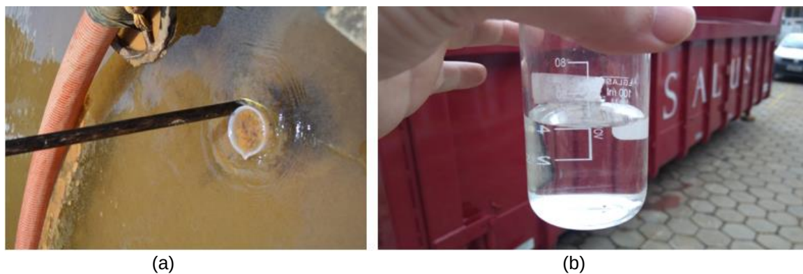
Figura 27 - (a) Lodo do decantador, (b) percolado após os primeiros desaguamentos
