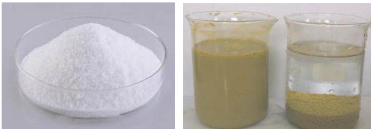
Figura 18 - Poliacrilamida aniônica e desestabilização de partículas com sedimentação
