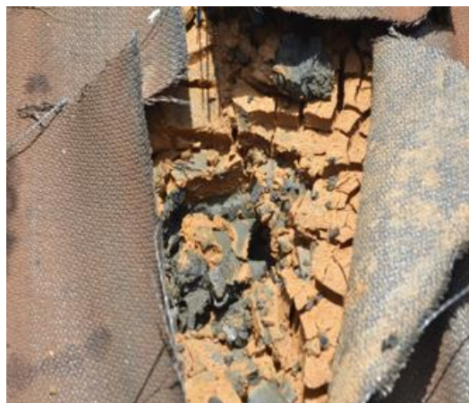
Figura 31 - SCR aberto. Visualização do interior do SCR (a) camada mais externa e (b) camadas mais internas
