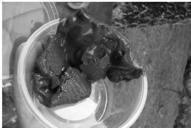
Figura 15 - Camada de filter cake formada durante processo de desaguamento com geotêxteis.
